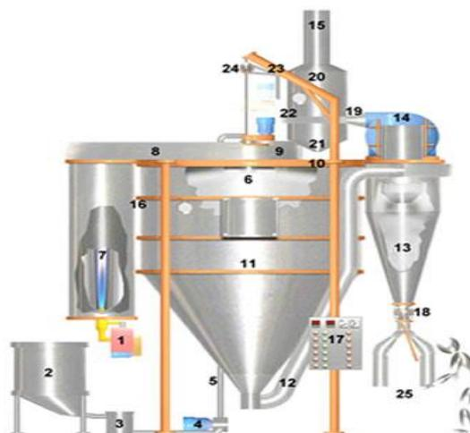
Figura 8: Esquema de secadero en spray [67]
