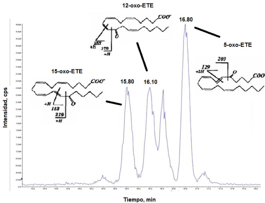
Fig.12. Cromatograma obtenido del HPLC-MS del ácido araquidónico almacenado durante 20 días seleccionando la relación  $m/z=317$ . Productos identificados con el método de “product ion scan” y la bibliografía.
