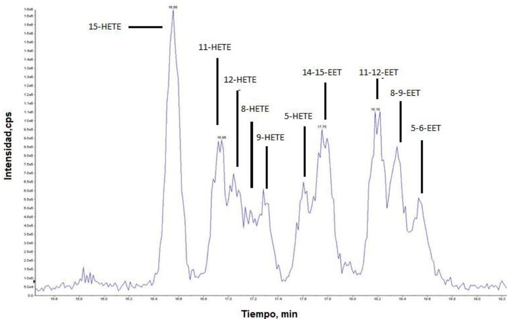
Fig.13. Cromatograma obtenido del HPLC-MS del ácido araquidónico almacenado durante 20 días seleccionando la relación  $m/z=319$ . Productos identificados con el método de “product ion scan” y la bibliografía.
