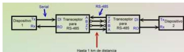
Figura 3.13. RS-485 con únicamente dos dispositivos seriales.
