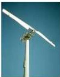
Aerogenerador de dos palas
