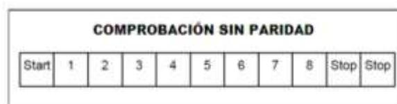
Figura 4.18. Secuencia de bits modo RTU sin paridad.
