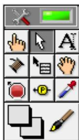
Se emplea tanto en el panel frontal como en el diagrama de bloques. Contiene las herramientas necesarias para editar y depurar los objetos tanto del panel frontal como del diagrama de bloques.
