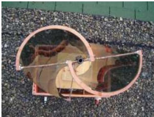
Figura 2.20. Palas aerogenerador Savonius.
