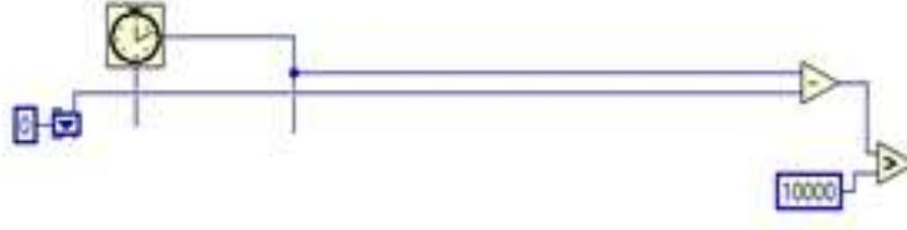
Comparo el tiempo para el panel solar fotovoltaico, si es mayor que 1000 milisegundos me devuelve un true y entonces entrará en la sentencia de control con un true, si es menor me devolverá un false y entrará en la sentencia de control con un false.
