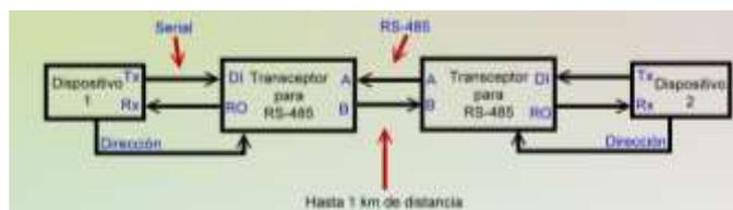
Figura 3.14. Conexión RS-485 con dos dispositivos.
