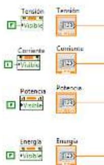
Son las variables de entrada al subvi, son vectores de dimensión 1 x n siendo n los datos que se hayan recogido ese día, el aerogenerador recogerá más datos que el panel solar fotovoltaico porque está diseñado para que recoja más datos, cada 500 milisegundos mientras que el panel solar fotovoltaico cada 1000 milisegundos.
