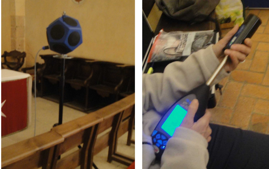
Ilustración 4-2. Fuente dodecaédrica y calibración del sonómetro previa a la medición. Fotografías propias.
