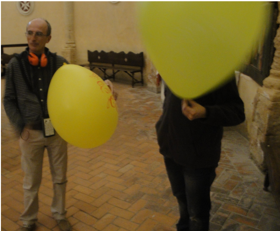
Ilustración 4-4. Globos grandes para medición del tiempo de reverberación. Fotografía propia.
