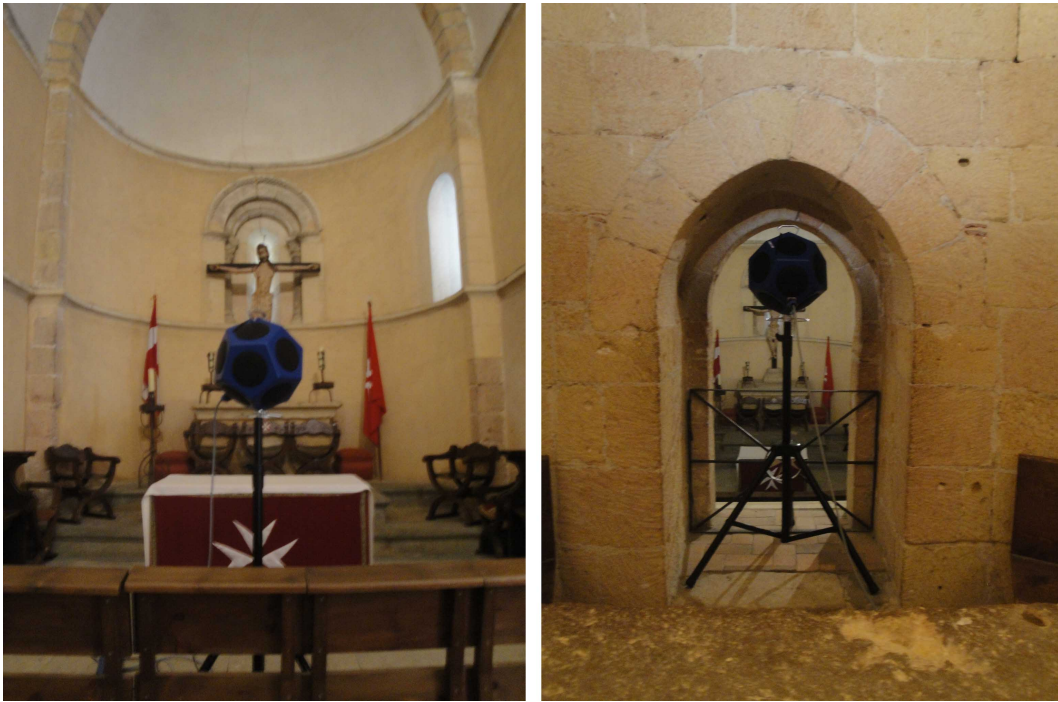
Ilustración 4-3. Fuente en las dos posiciones: izquierda, posición F1; derecha, posición F2. Fotografías propias.
