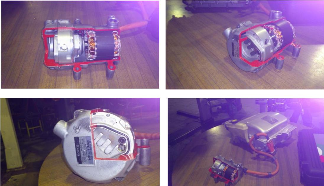
Fig. 3.13 Diversas vistas de un compresor de climatización de un vehículo híbrido.
