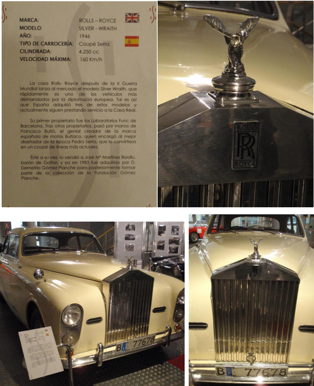
Fig. 7.11 Diferentes fotografías del vehículo Rolls-Royce con persiana delante del radiador
