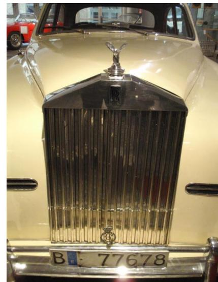
Fig. 7.6 Trampillas delante del radiador
