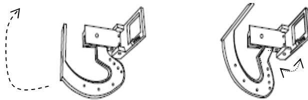
Diseño 4. 11 Movimiento bisagras
