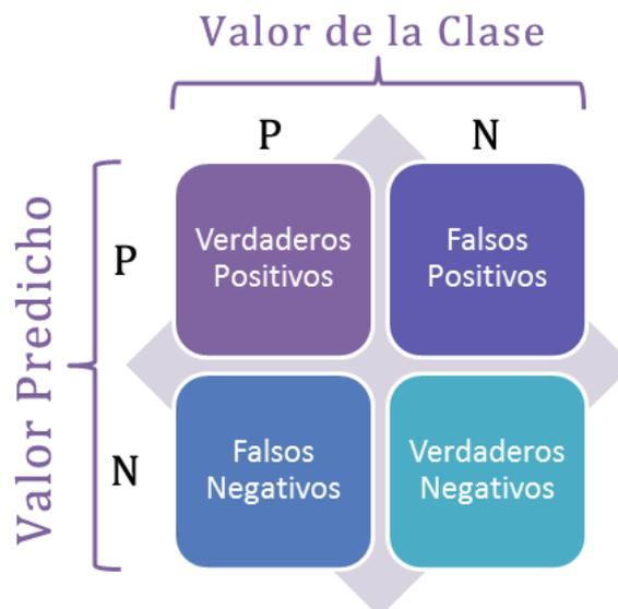
**Figura 4-9.** Matriz de confusión que recoge los cuatro posibles resultados tras aplicar un clasificador binario: las columnas establecen el valor real de la clase y las filas el valor predicho por el clasificador.
