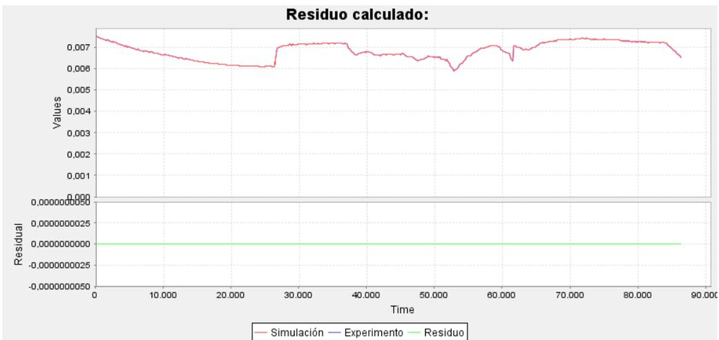
Figura 75: Experimento del 1 de Junio de 2013. Arriba, diferencia entre la humedad específica del aire nominal (azul) y con el fallo MF06 en  $t = 43000s$  (rojo). Abajo, valor del residuo del Posible Conflicto 02 (verde).
