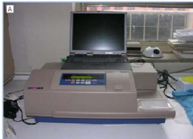
**Figura 4:** Equipo multilector de placas SpectraMax® M5 con su ordenador asociado.
