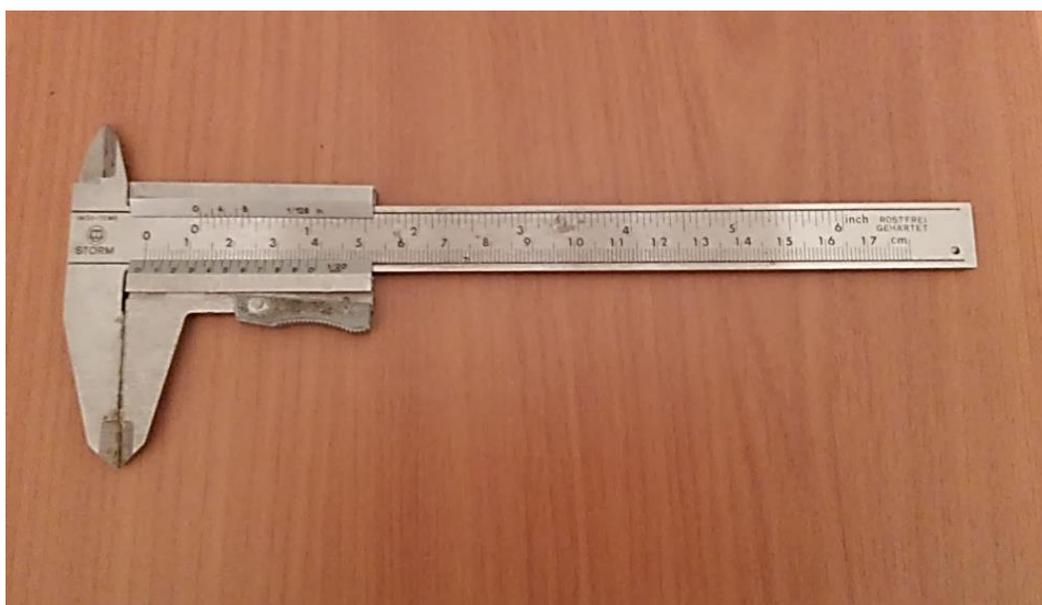
**Figura 4.12.** Calibre de 20 cm Inox-Temp marca Storm. Aproximación de 0,1 mm
