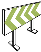
VALLAS DESVIO TRAFICO
