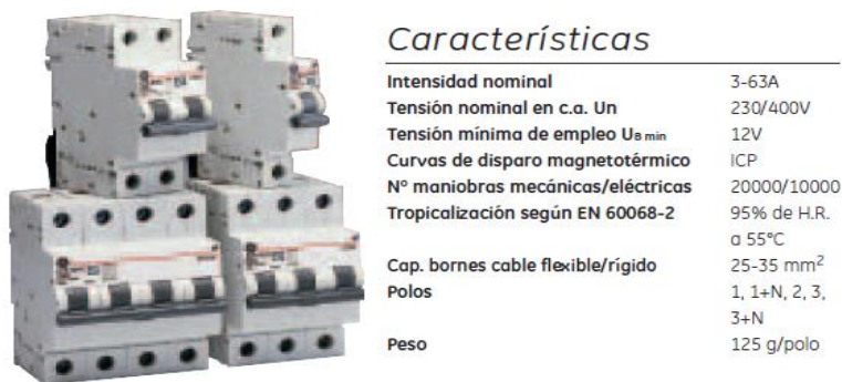
Figura 10. Imagen de los magnetotérmicos elegidos y sus características (Fuente: Catálogo 2015 Power protection. GE Consumer & Industrial).
