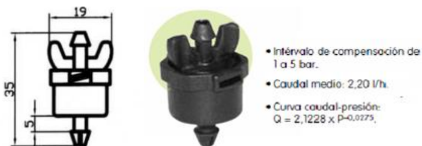
Figura 1. Características técnicas de los goteros elegidos. (Fuente: Catálogo Plasgot 2014)
