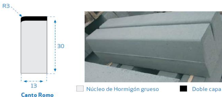
Figura 2. Perfil acotado e imagen del bordillo utilizado. (Fuente: Catálogo 2014 materiales de obra civil Jorge Fernández)
