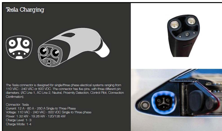
Ilustración 23 : Conector Tesla. Fuente: EV institute
