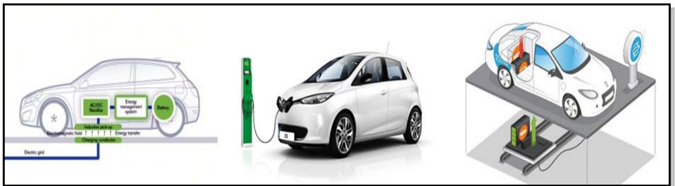
Ilustración 18: Inductiva (izda), conductiva (centro), intercambio de baterías (dcha).
