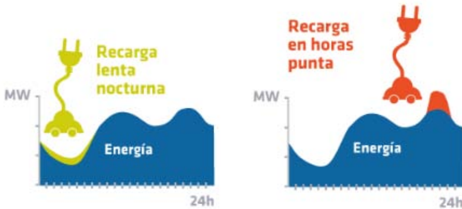
Ilustración 142: Interferencia en la curva de demanda de los VE. Fuente: REE
