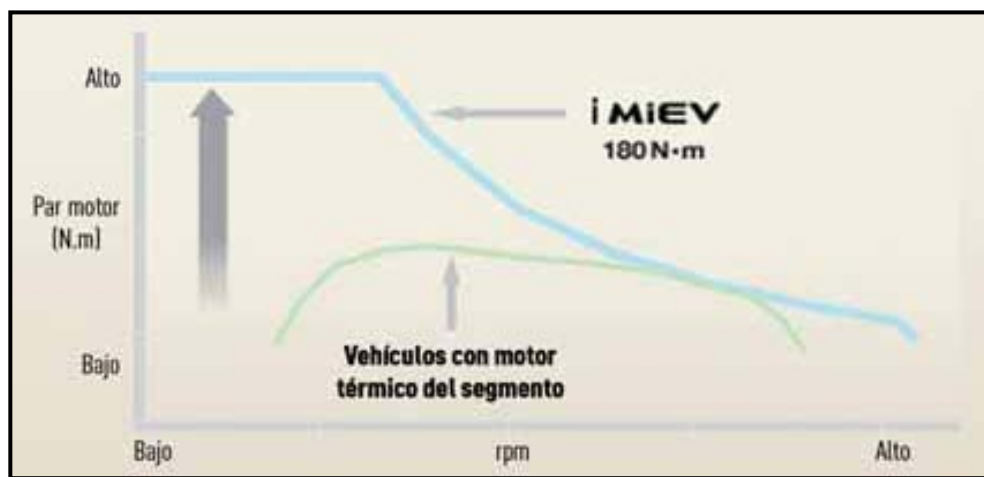
Ilustración 97: Representación comparativa del par motor coche eléctrico vs coche térmico. Mitsubishi i-MiEV. Fuente: Cesvimap.
