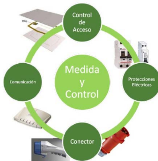
Ilustración 141: Elementos básicos constitutivo de los sistemas de recarga. Fuente: Iberdrola
