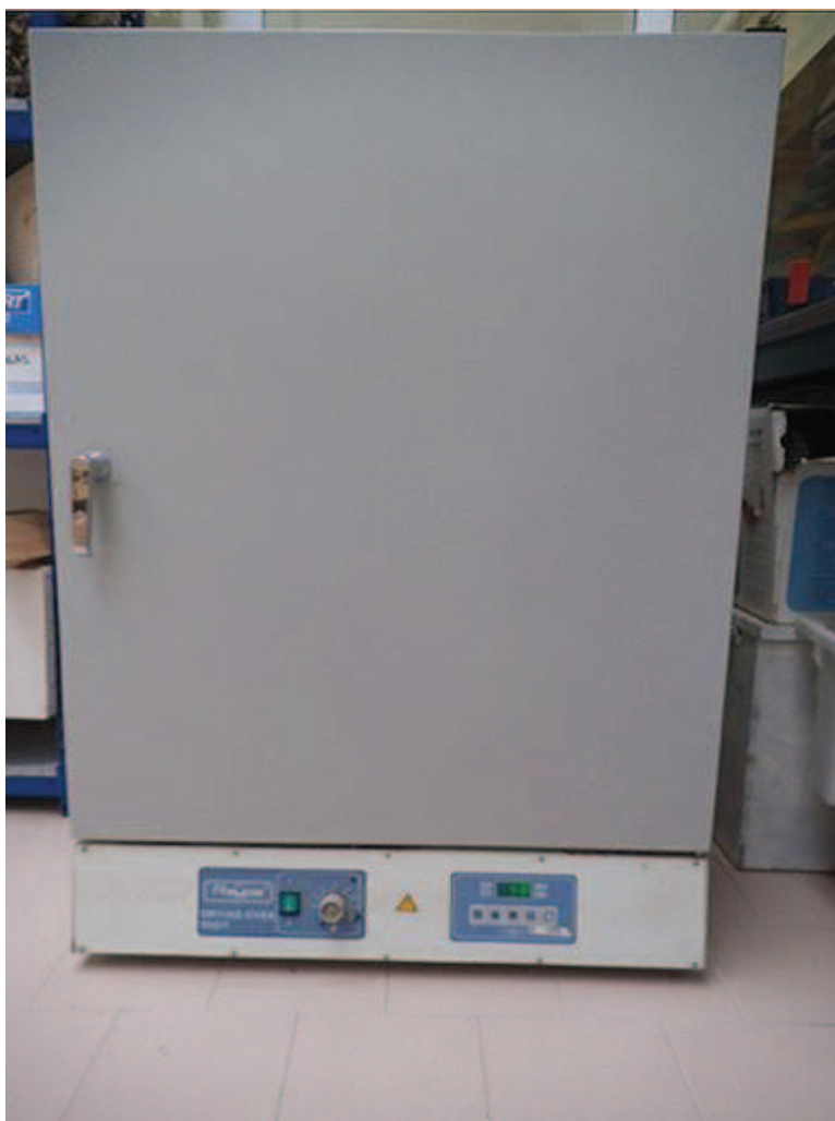
Figura 11 – Estufa de circulación de aire
