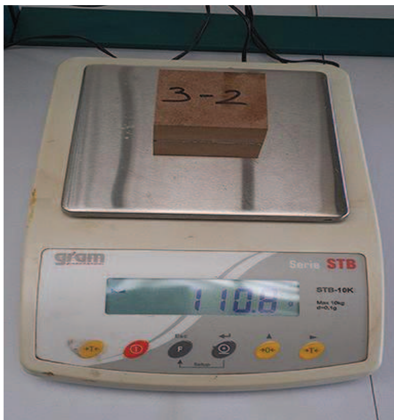
Figura 21 – Medición del peso de la muestra anterior a su secado
