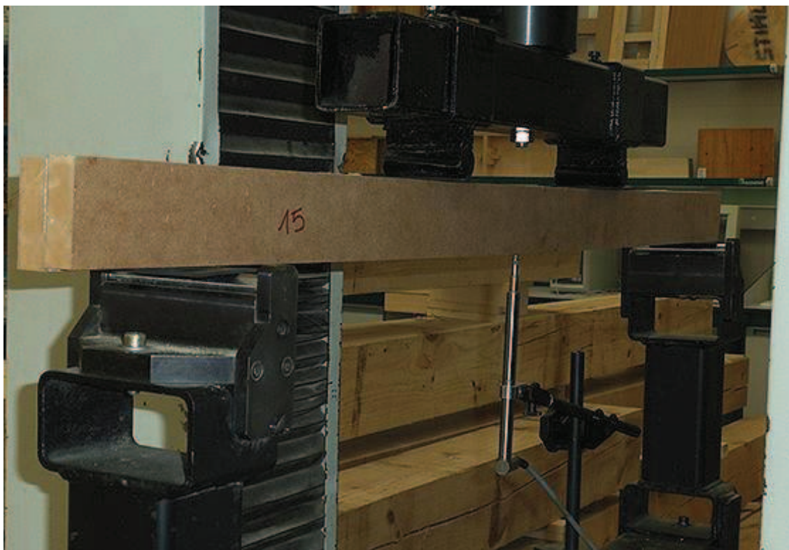
Figura 9 - Colocación del extensómetro
