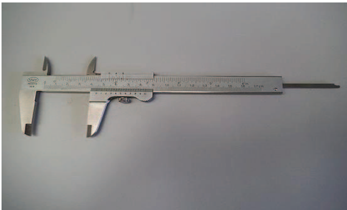
Figura 23 – Calibre de medición para determinar el volumen de las probetas
