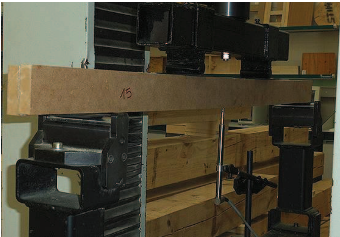
Figura 13 – Colocación de extensómetro para medir deformación en punto medio de la probeta
