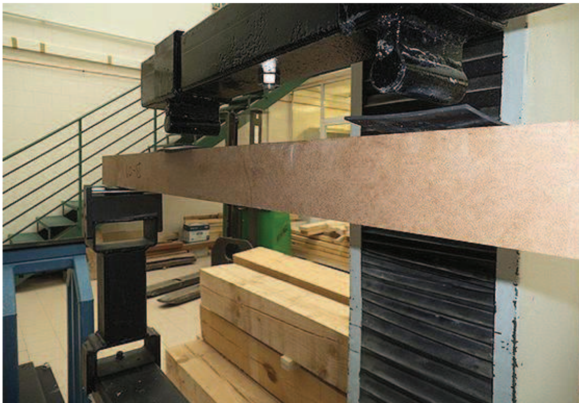
Figura 8 – Acoplamiento de las vigas en la Máquina de ensayos
