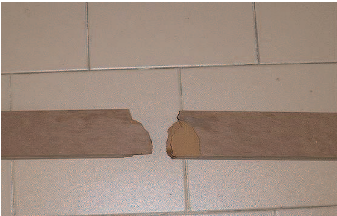
Figura 18 – Rotura de probeta de tablero MDF sin refuerzo de fibra de vidrio
