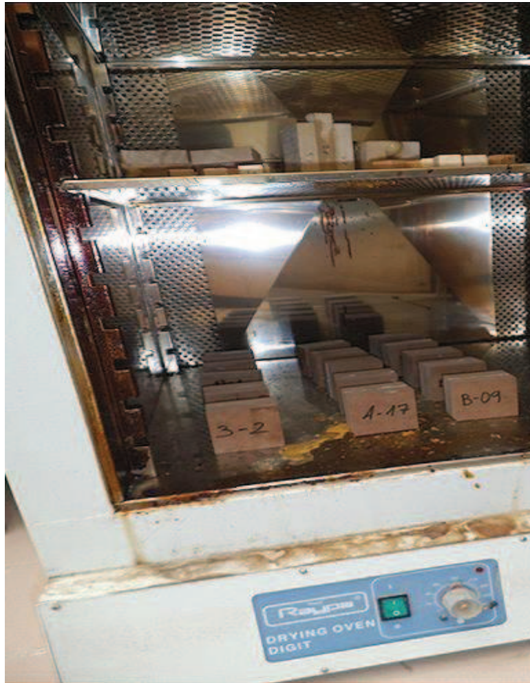
Figura 22 – Secado de las muestras en estufa a 103 \pm 2 \text{ }^\circ\text{C}
