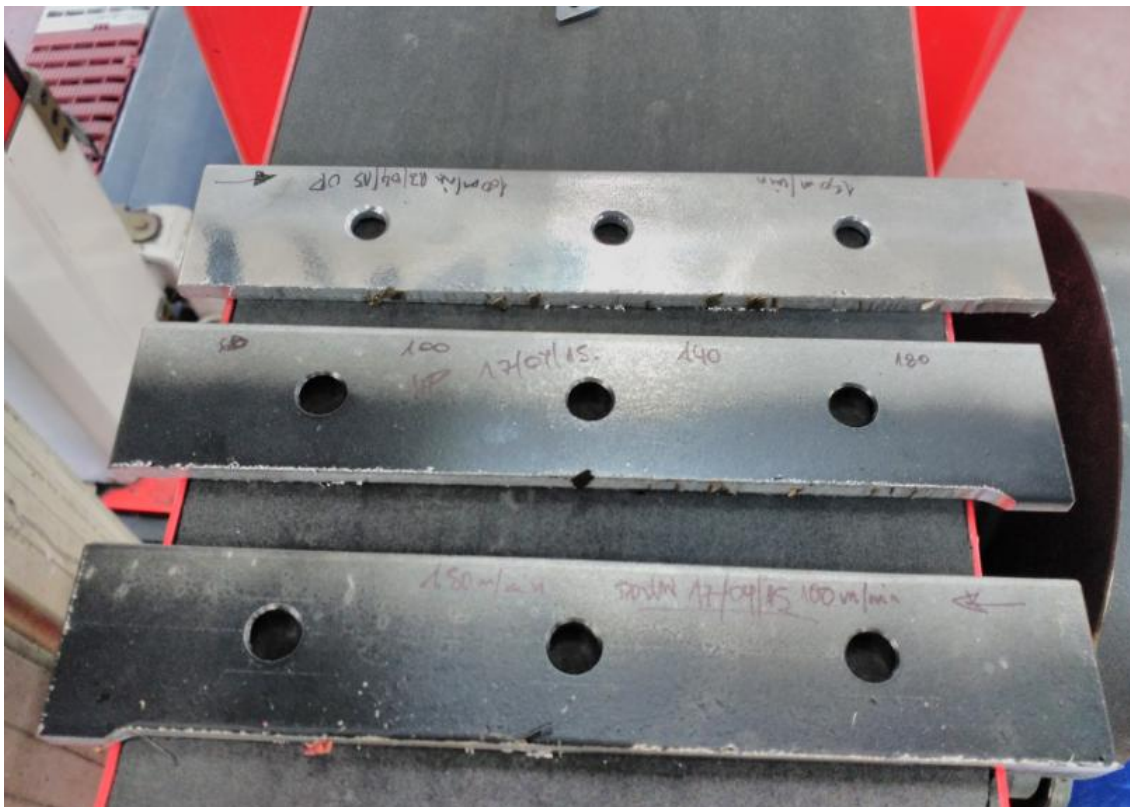
Imagen 31. Placas de acero AISI 316-L ASS utilizadas para la realización de los ensayos
