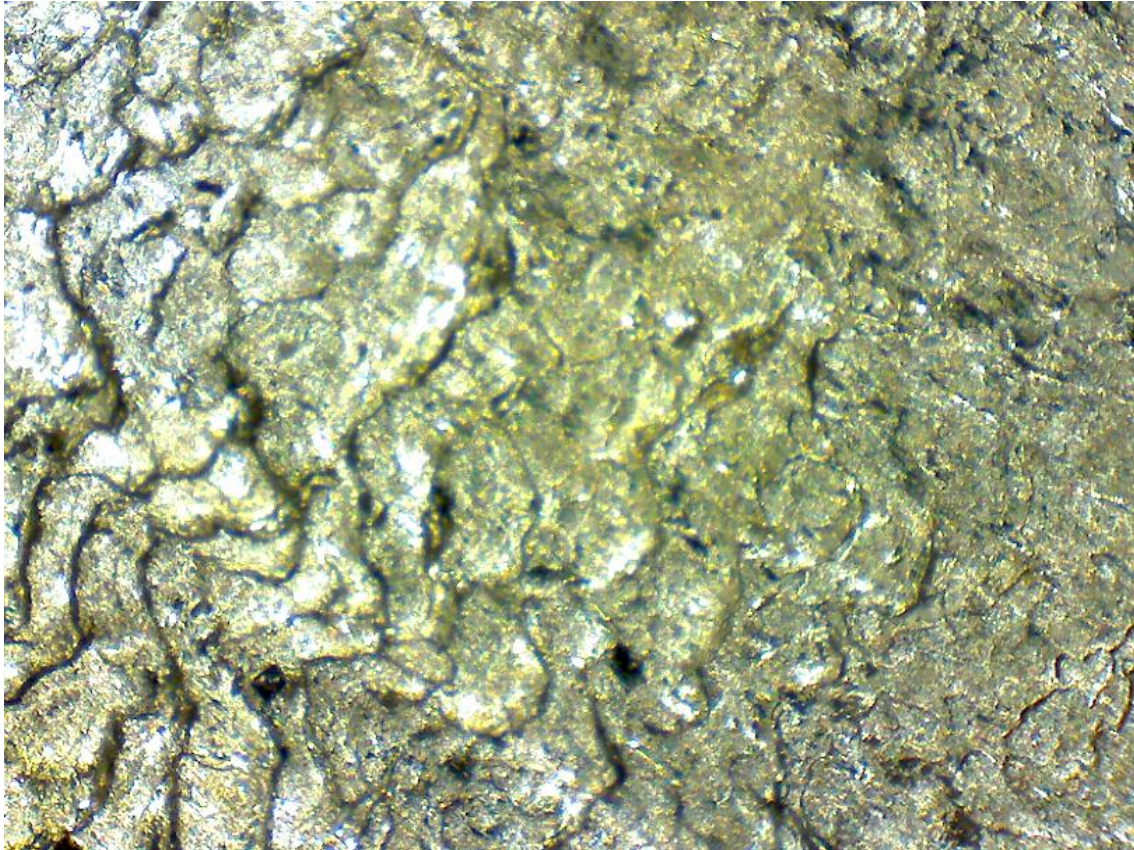
Imagen 97. Micrografía para fresado en oposición con V_c = 180 (m/min), f_n = 0,15 (mm/rev)
