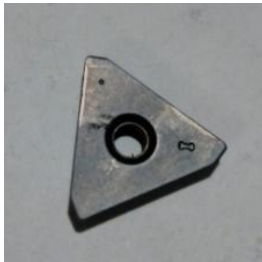
Imagen 29. Plaquita "TPKN 1603 PPTR-42 IC328" utilizada en los ensayos
