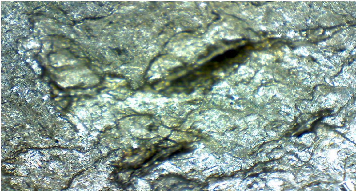
Imagen 92. Micrografía para fresado en oposición con V_c=100 (m/min), f_n=0,1 (mm/rev)
