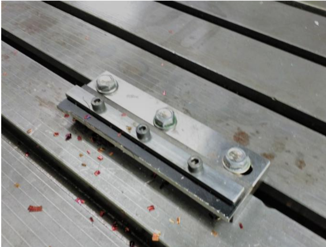
Imagen 30. Amarre de las placas en la mesa de la máquina fresadora utilizada para los ensayos
