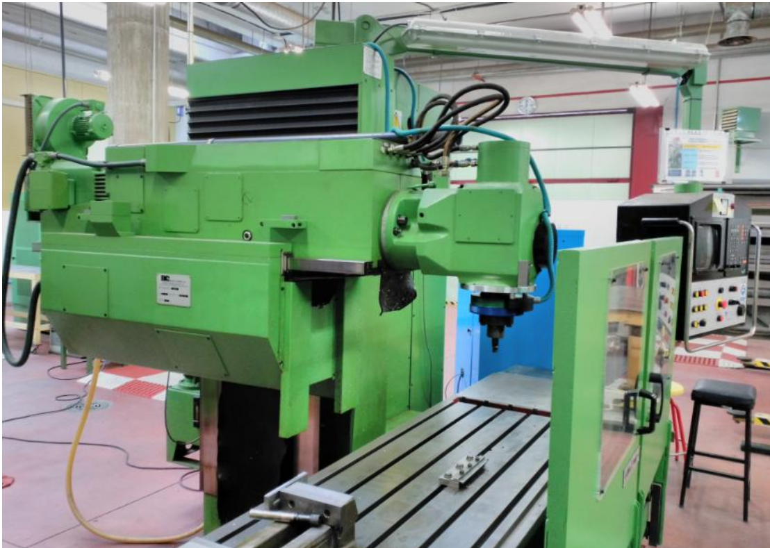
Imagen 21. Máquina fresadora "Correa A16" con la cual se han realizado los ensayos, situada en el laboratorio de fabricación de la Escuela de Ingenierías Industriales de Valladolid
