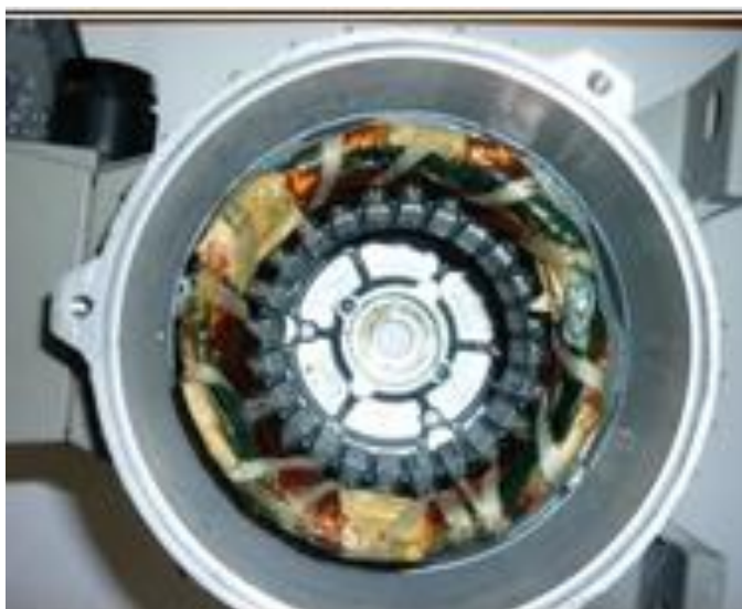
Figura 6. Estator jaula de ardilla
