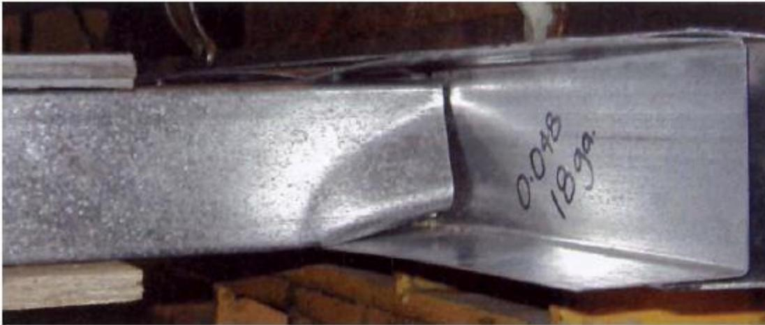
Figura 9-Colapso del alma junto a los apoyos
