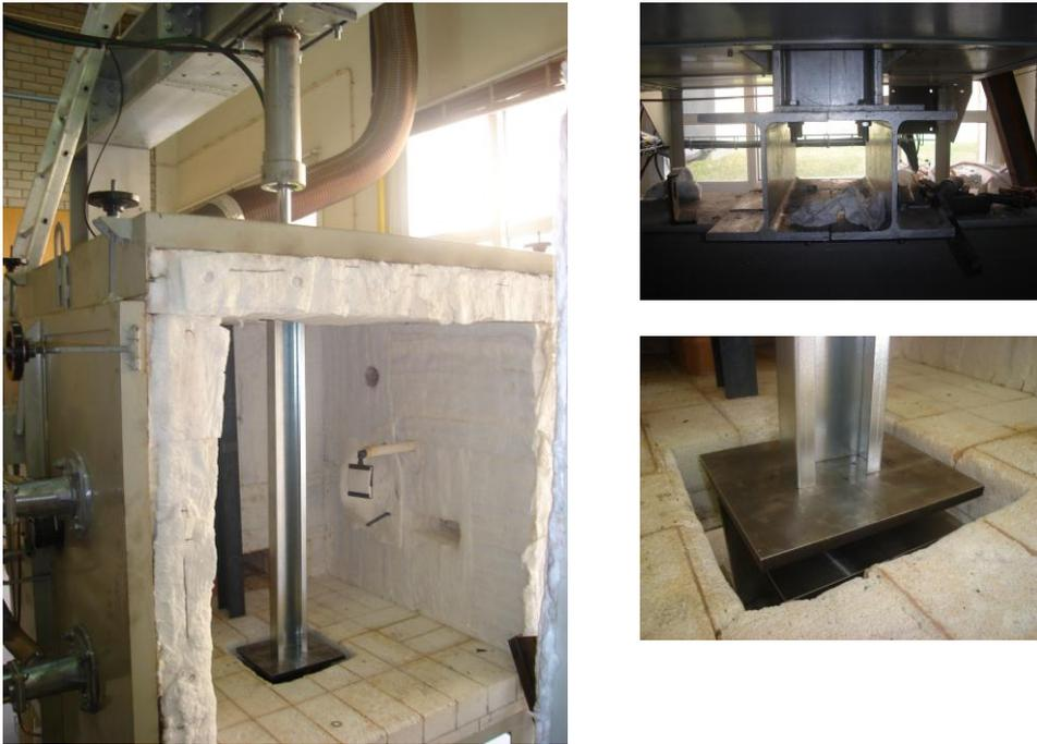
Figura 91- Setup de análisis de elementos a compresión
