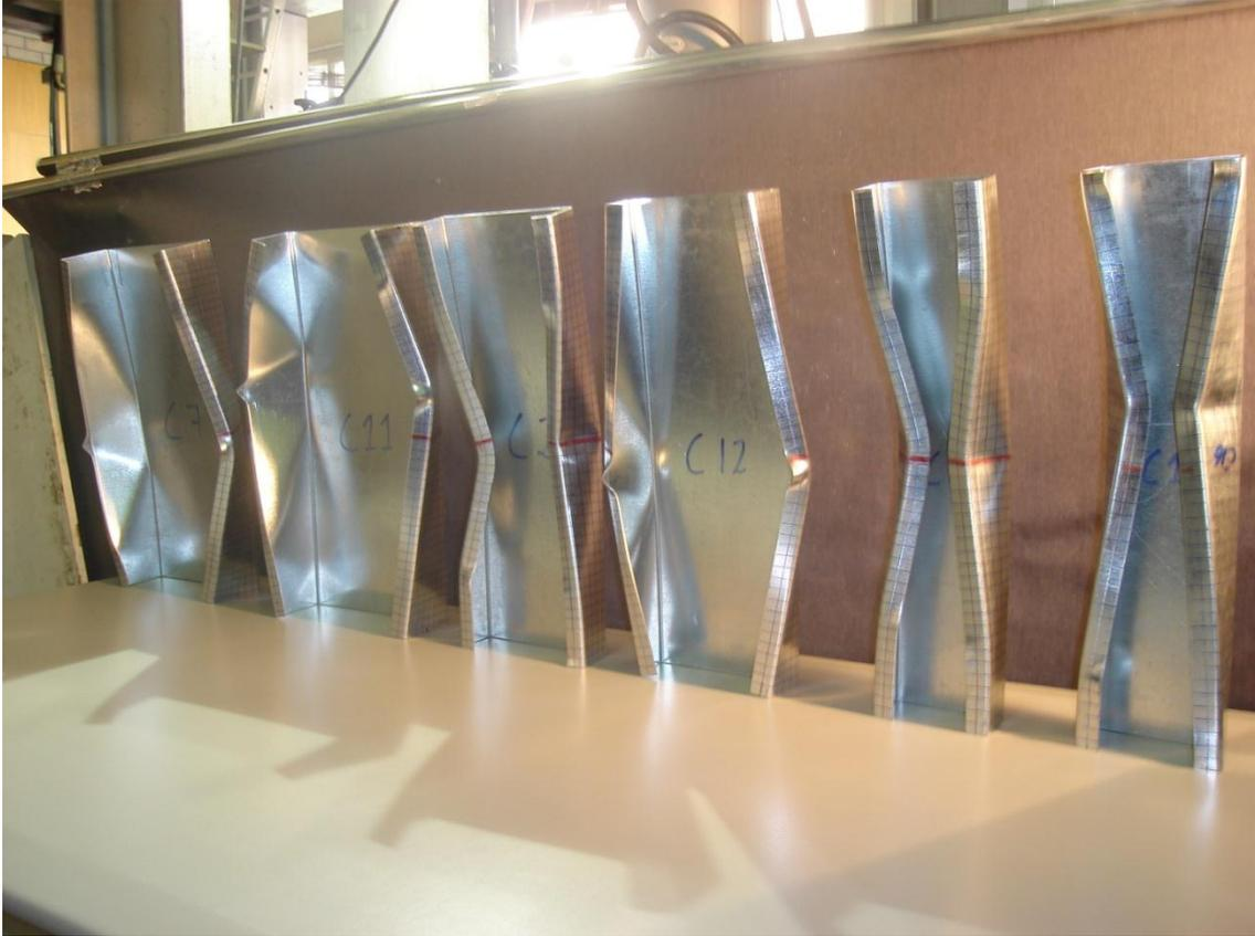
**Figura 88- deformación del perfil después de un ensayo de compresión**
