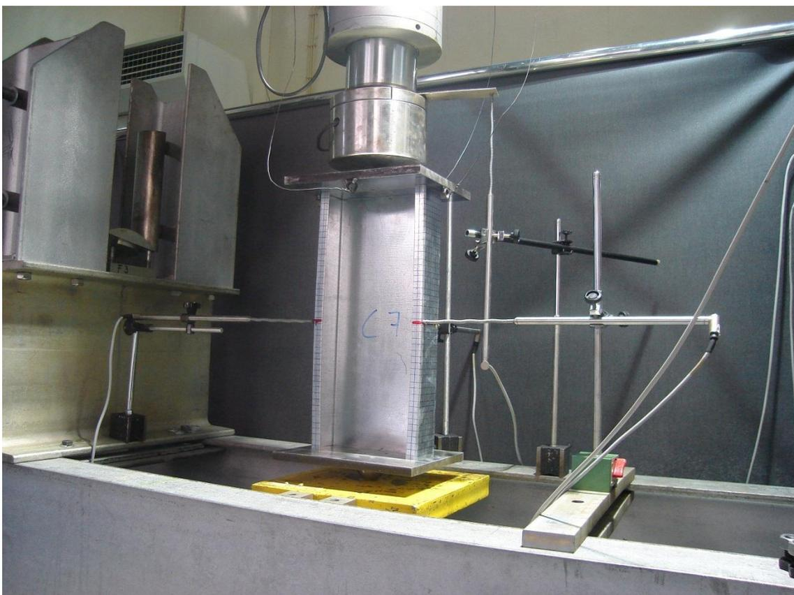
**Figura 57- Estado 2 del perfil C7 a compresión**
