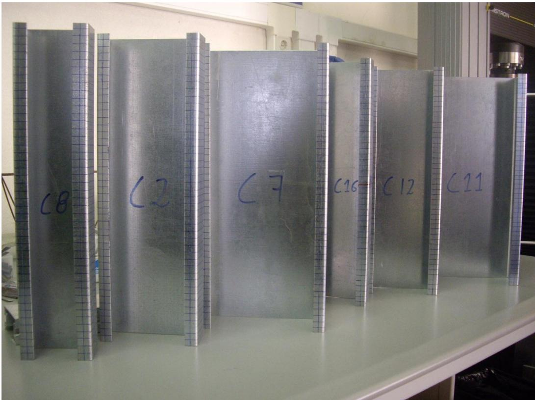
**Figura 45-perfiles ensayados a compresión**
