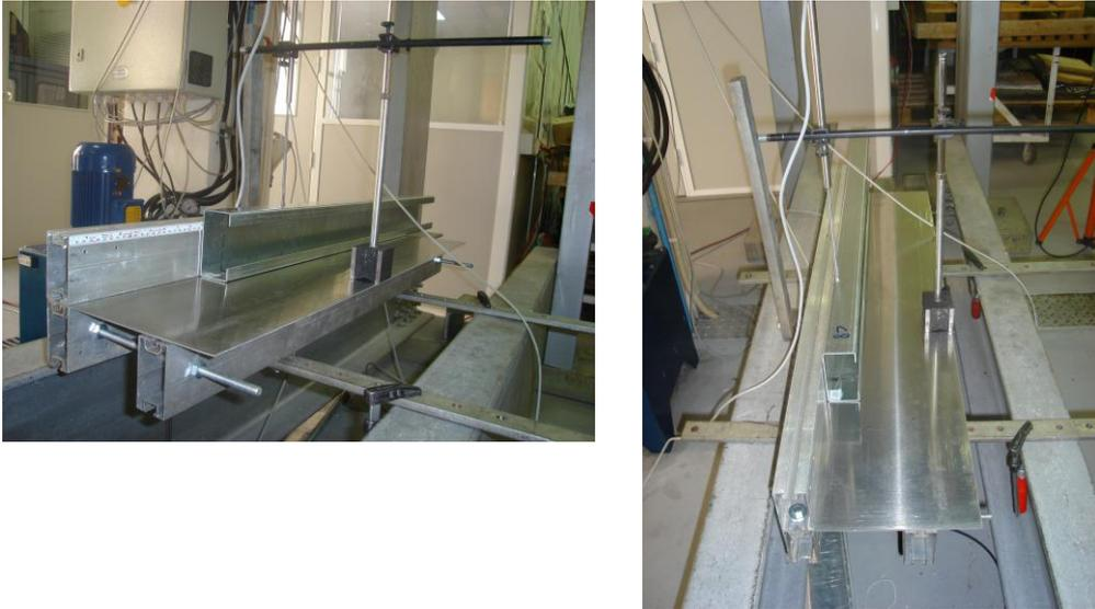
Figura 89- Setup para la medición de imperfecciones
