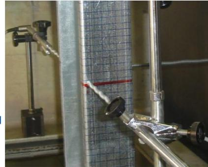
**Figura 44- Colocación de LVDT en el perfil**
