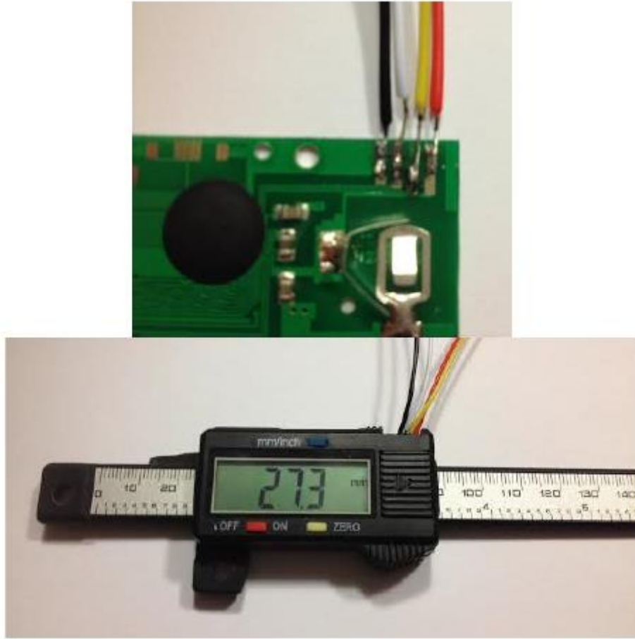
Figura 3.37. Cables soldados al calibre digital.
