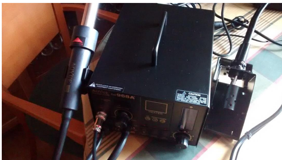
Figura 3.45. Estación de soldadura
