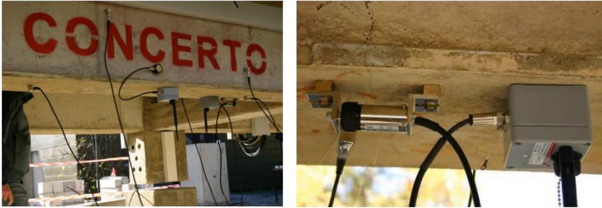
Figura 2.21. "Concerto Bridge" equipado con sensores inalámbricos acústicos (izquierda) y de tensión (derecha). (Christian Grosse, 2010)
