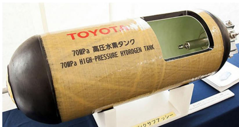
Figura 25: Depósito de hidrógeno Toyota
