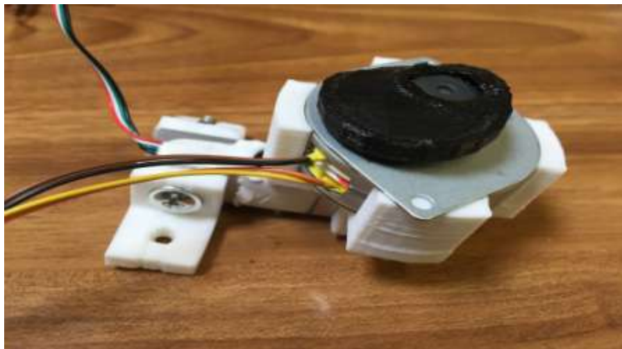
Figura 8.29 Excéntrica (nótese que se encuentra alojada en la célula de carga)
