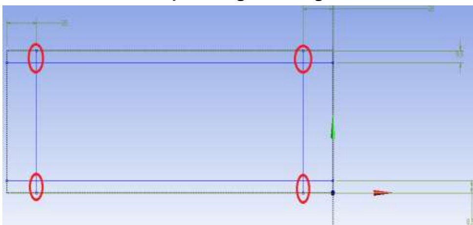
Figura 5.7 Aristas extruidas para la creación de los tornillos
