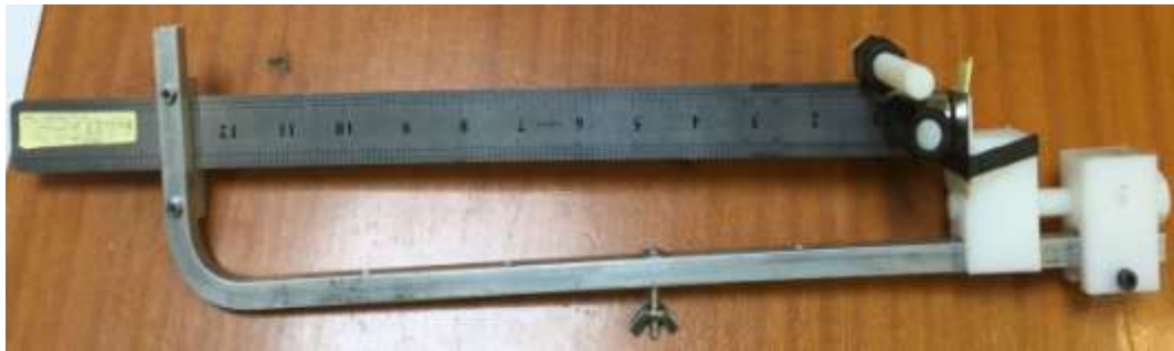
Figura 8.6 TMD empleado en el análisis dinámico
