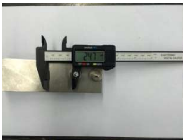
Figura 4.2 Unión del calibre a la pletina
