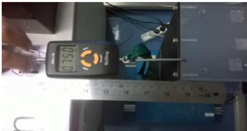
Figura 3.1 Medida de la rigidez combinada
