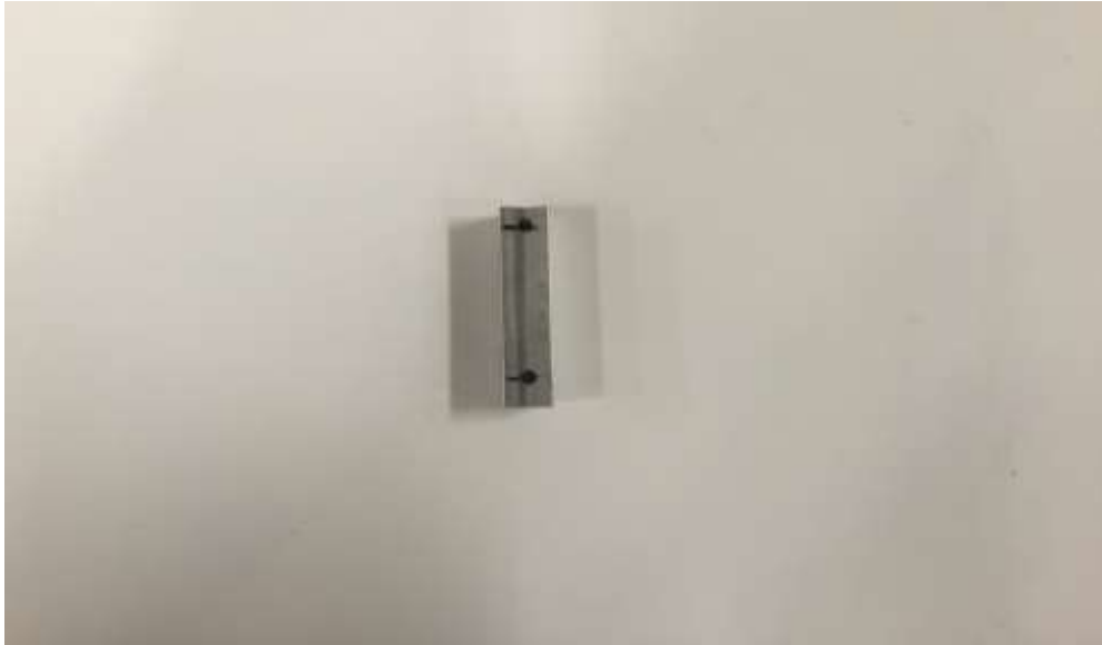
Figura 8.3 Soporte empleado para fijar la regla al bastidor
