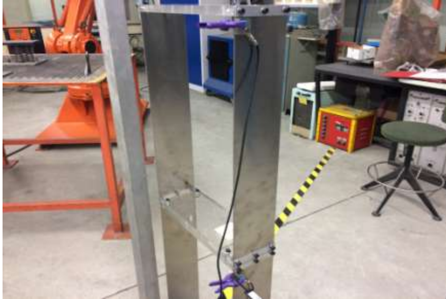
Figura 4.4 Sensores empleados para medir las aceleraciones
