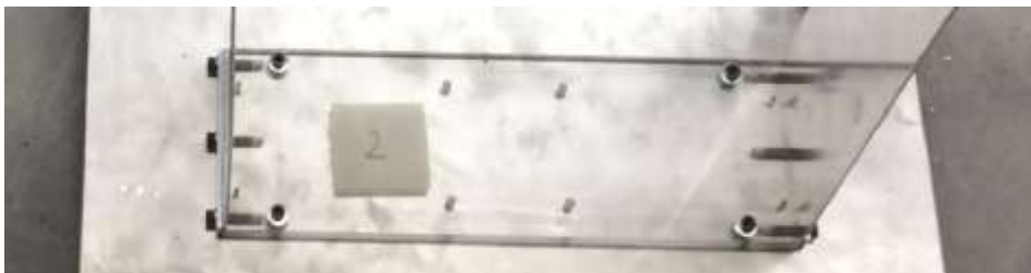
Figura 3.14 Unión del piso inferior a la base
