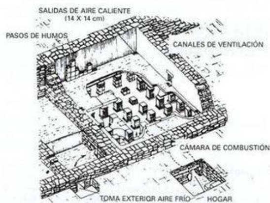
Figura II.2. Ejemplo de los primeros sistemas de calefacción radiante: hipocausto romano [Vallejo D., Arqueología romana en Hispania]
