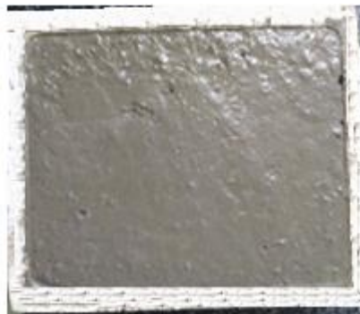
Figura III.26. Pesado de hormigón húmedo
