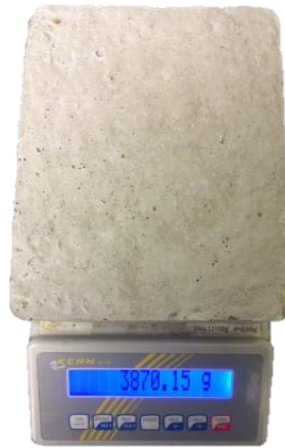
Figura III.27. Pesado de hormigón seco
