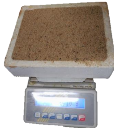
Figura III.25. Pesado de arena
