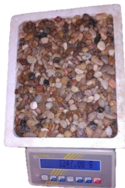
Figura III.24. Pesado de grava
