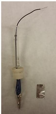
*Imagen 3.21: Soporte para el electrodo auxiliar y placa de platino*
