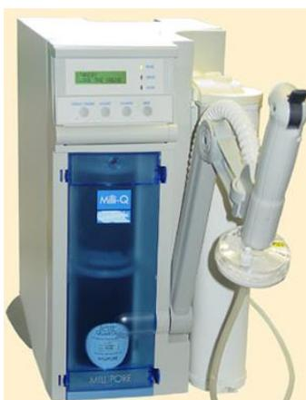
Imagen 3.34: Equipo de destilación y deionización de agua: MilliQ MILLIPORE, modelo Progard<sup>®</sup> 2
