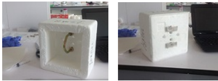
Figura 26: a. Tornillo en u, utilizado para colocar un doble electrodo. b. Vista frontal de las placas paralelas.
