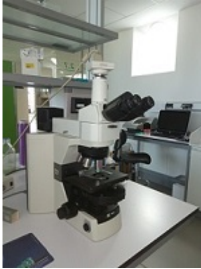
Figura 20: Microscopio óptico Nikon eclipse 80 i utilizado en las observaciones.
