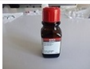
Figura 3: Trifluoroetanol ( CF_3H_2OH ), disolvente utilizado para las disoluciones de polímeros.
