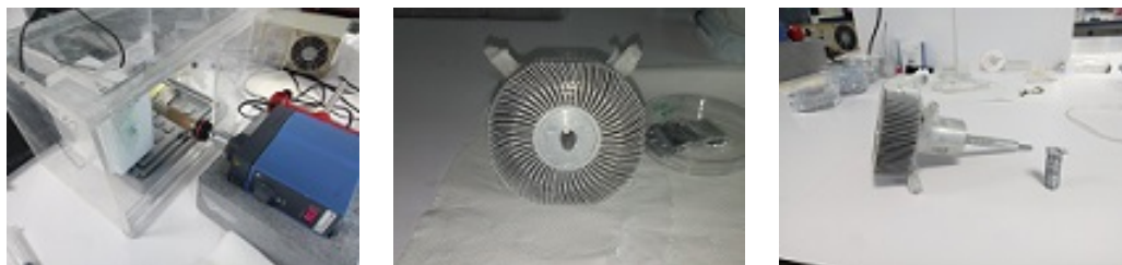
Figura 30: a. Colector con tubo rotatorio simple. b. Parrilla rotatoria utilizada como segundo. c. Parrilla rotatoria con eje.
