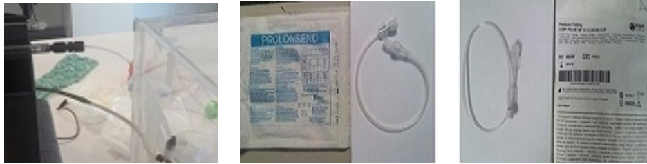
Figura 23: a. Tubos capilares multietapa PTFE del estado inicial. b. Tubos plásticos monoetapa solubles al disolvente 2,2,2 TFE. c. Solución adoptada, material plástico no soluble (Argon Comp PR Line10 in CLR)
