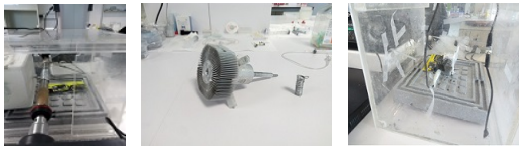
Figura 31: a. Tubo metálico simple. b. Parrilla unida a eje para conectar al agitador y escobilla par conexión a tierra. c. Ensayo estático con parrilla desnuda.
