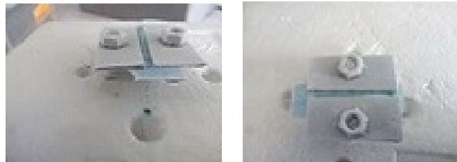
Figura 29: Lámina de plástico entre las dos placas colectoras.
