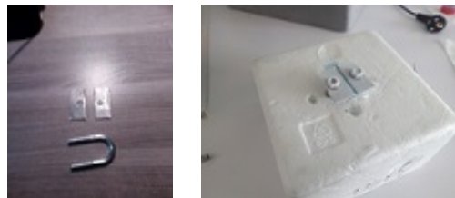
Figura 27: a. Nuevo electrodo de 21 mm de separación. b. Montaje con placas de aluminio.
