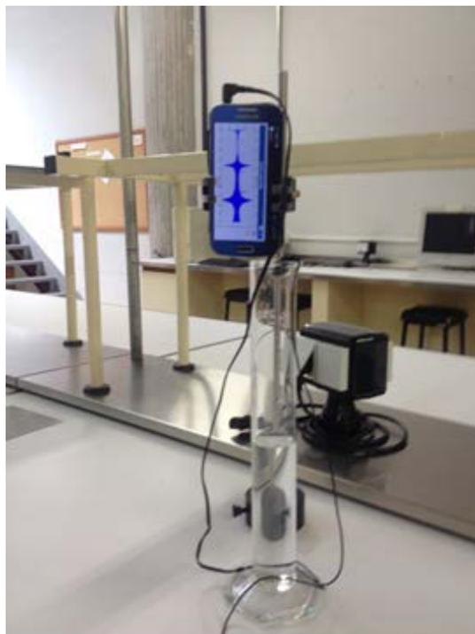
**Figura 2.** Montaje experimental para el estudio de Ondas Estacionarias en Tubos
