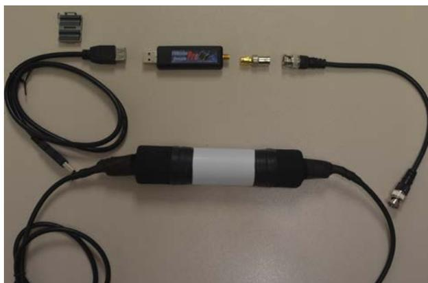
Figura 2. Adaptación del SDR FCD al uso en prácticas incluyendo una protección cilíndrica y cableado.
