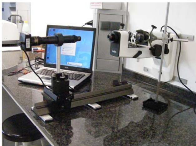
**Figura 3.** Sistema de alineamiento y grabación de video tutoriales para el manejo del frontofocómetro.
