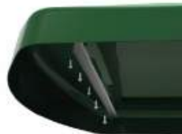
Figura 83. Perfil L colocado en la carcasa.
