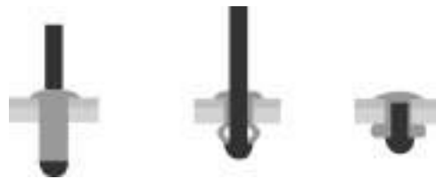
Figura 68. Funcionamiento remaches POP.
