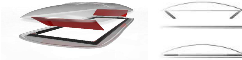
Figura 28. Paneles fijados en la parte superior.
