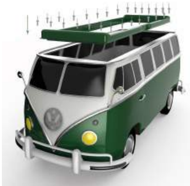
Figura 72. Remachado del marco de refuerzo.
