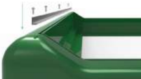
Figura 82. Perfil L sobre el marco de refuerzo.
