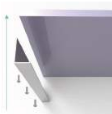
Figura 75. Unión de los perfiles en L 30x20x2
