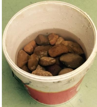
Figura II.12 Conjunto de piedras con agua para cálculo de volumen desalojado.
