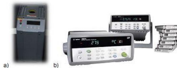
Figura II.8 a) Horno de calibración de temperatura 'FLUKE 9103', b) adquisidor de datos 'Agilent 34972A'.
