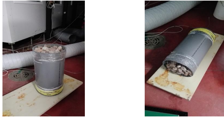
Figura II.2 Sistema de piedras en tubo PVC
