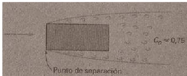
Morro de bordes vivos con flujo separado a lo largo de toda la superficie lateral y con coeficiente de resistencia C_x o C_D grande. C_D = 0.74 .
