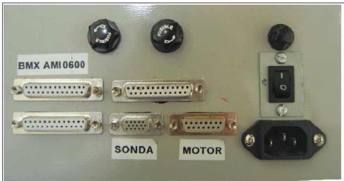
*Figura 2.6.7.1 Aspecto de las conexiones de la caja de mando*
