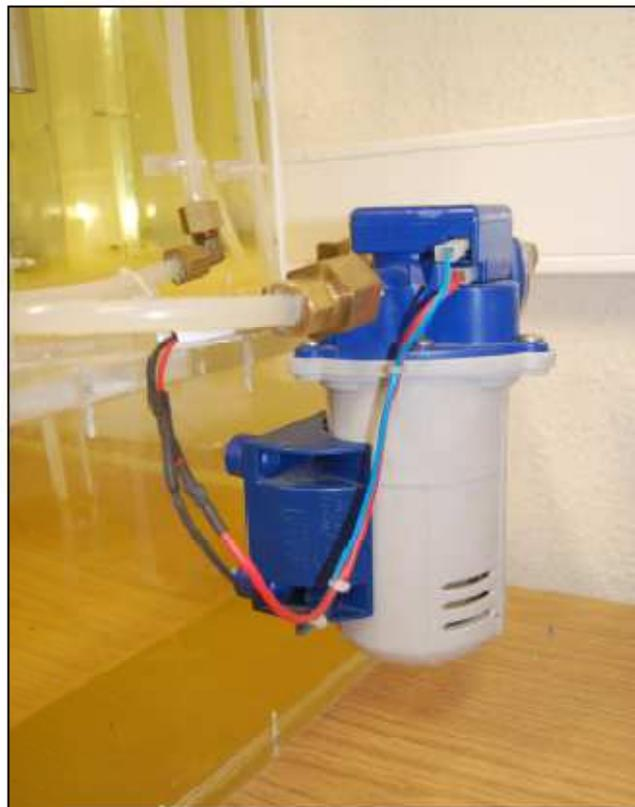
*Figura 2.3.1 Aspecto exterior de la autobomba Fiamma SuperFlow SF126 Pro*
