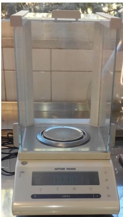
Figura 26. Balanza analítica Mettler Toledo.
