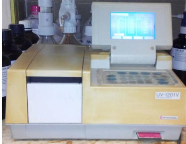
Figura 5. Espectrómetro de UV-Vis Shimadzu UV-1201 V
