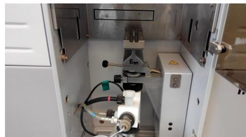
Figura 19. Posición del quemador en emisión.
