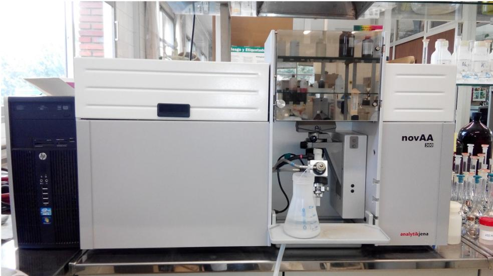
Figura 12. Espectrofotómetro de absorción atómica ANALYTIKJENA AAS novAA 300 bu.
