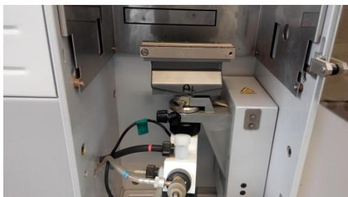
Figura 18. Posición del quemador en absorción.
