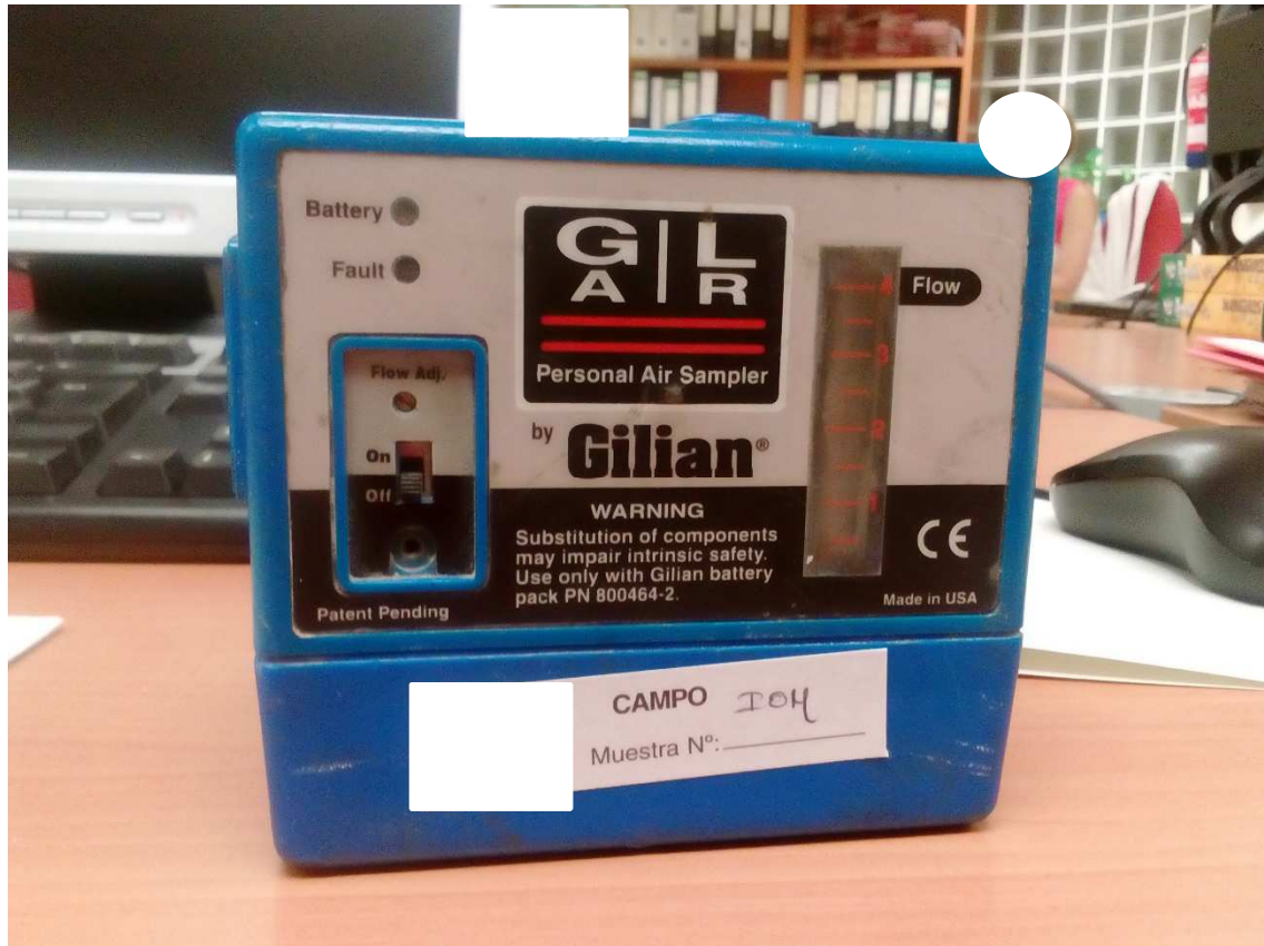
Foto 2: Bomba de alto caudal.
