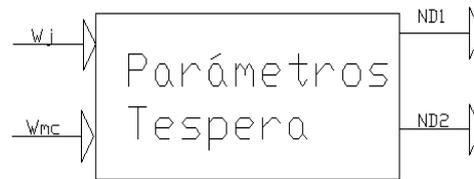
El objetivo que se pretende alcanzar en este capítulo es la obtención del modelo matemático del proceso. Este proceso consta de dos entradas que son los caudales de jarabe y el de masa cocida, introduciendo los valores de unos parámetros y el tiempo de espera entre ciclos se obtiene en nivel de los dos depósitos.
