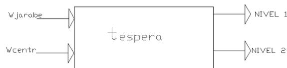
Las condiciones de contorno son los flujos de entrada al depósito 1 y de salida del depósito 2.
