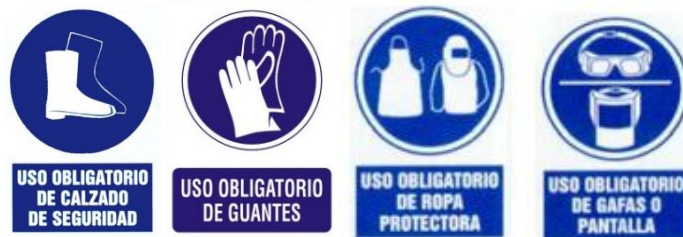
Figura 5.7. Protecciones obligatorias para trabajos de soldadura
