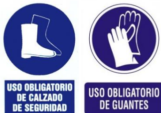
Figura 5.3. Protecciones obligatorias cizalla
