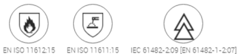
Figura 5.6. Normativa de ropa protectora de soldadura con simbología
