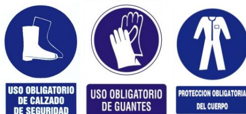
Figura 5.4. Protecciones obligatorias cizalla hidráulica
