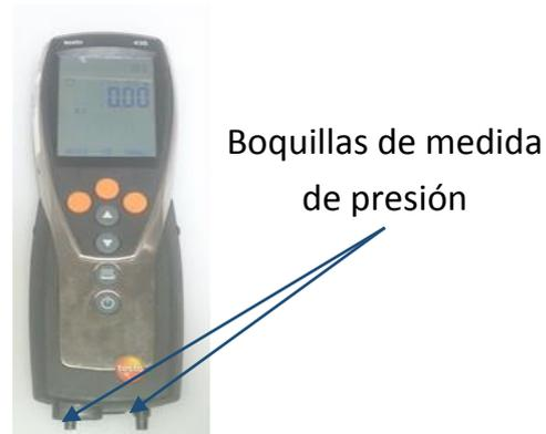
*Figura 11 - Imagen del Instrumento de Medida de Presión Utilizado*
