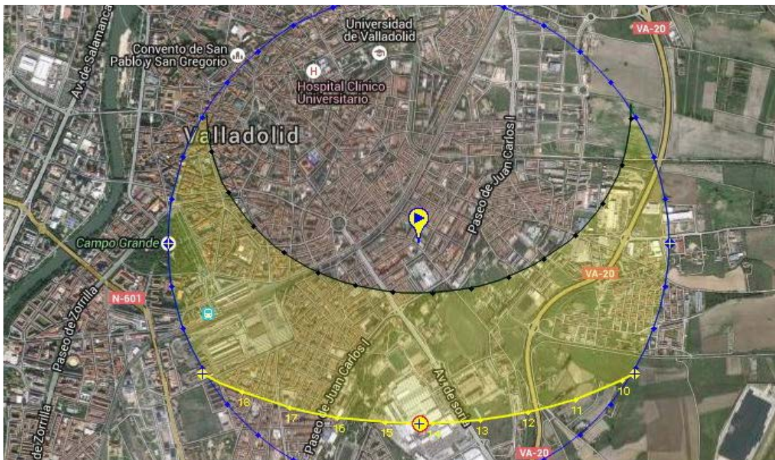
Imagen 33. Coordenadas polares de la situación del sol el 21 de diciembre a las 14:16 horas, cuando alcanza su posición más elevada. © 2009-2016 SunEarthTools.com
