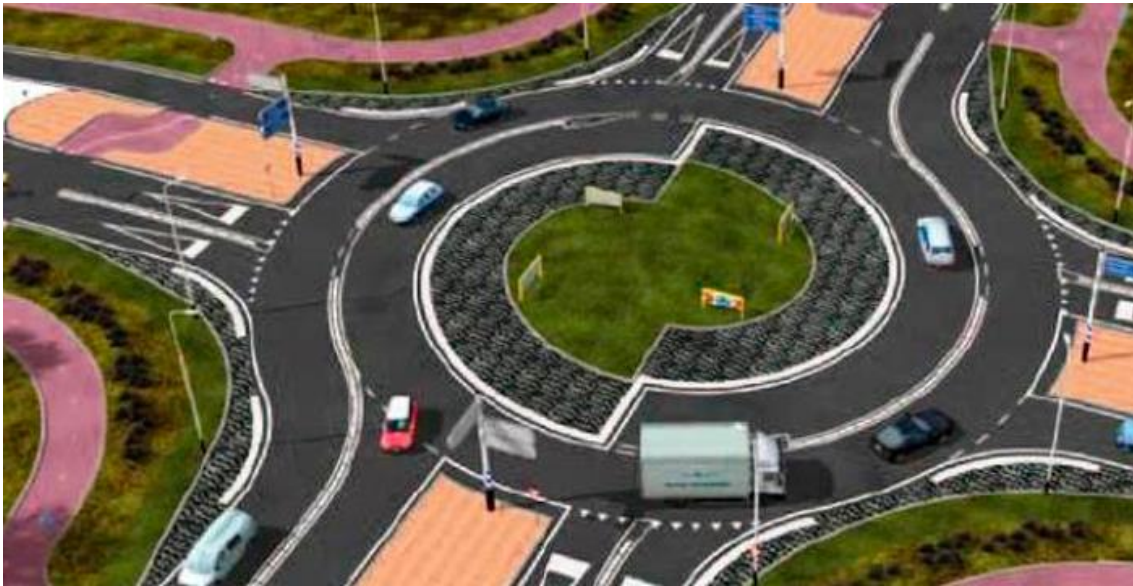
Figura 9. Esquema de una turbo rotonda
