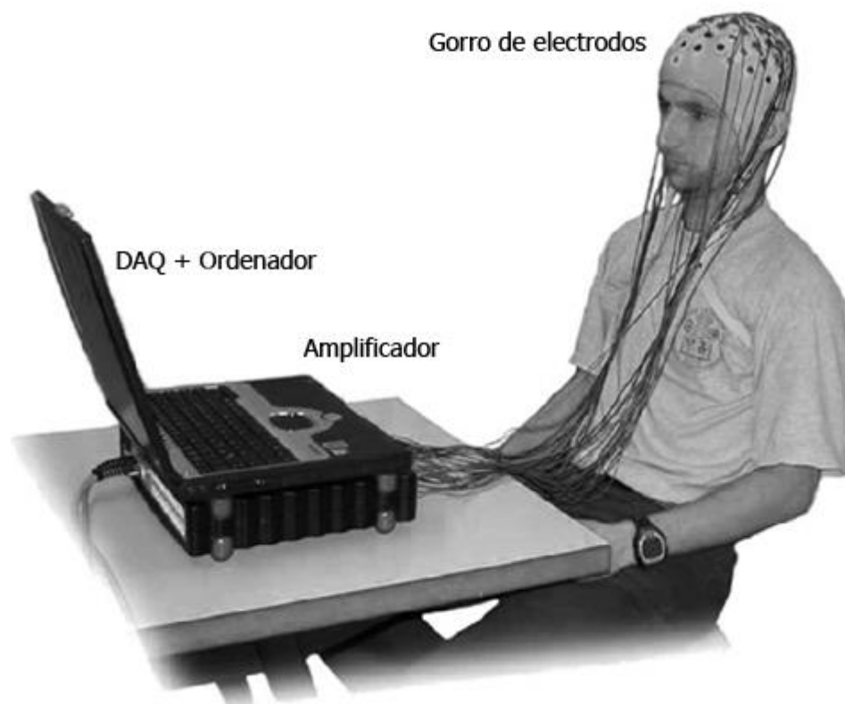
Figura 1-6. Sistema BCI basado en EEG. La señal es captada mediante electrodos colocados en el gorro, y mediante los cables se transmiten hasta el amplificador. Este dispositivo la amplifica y acondiciona para convertirla al dominio digital y la transmite al ordenador, donde se realiza el procesado [7].
