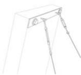
LOS MÁSTILES DE CUBIERTA SON PIEZAS DE MADERA DE PROPORCIONES SIMILARES A LAS UTILIZADAS EN LA BASE DEL ESCENARIO Y SU ALTURA ES VARIABLE DEPENDIENDO DE LA POSICIÓN DE CADA UNO.
