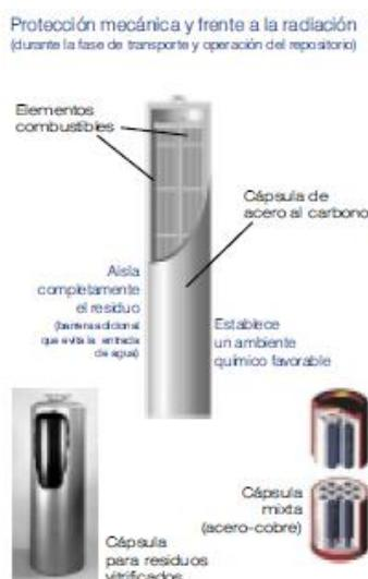
Figura 4.21. Cápsulas metálicas [23]
