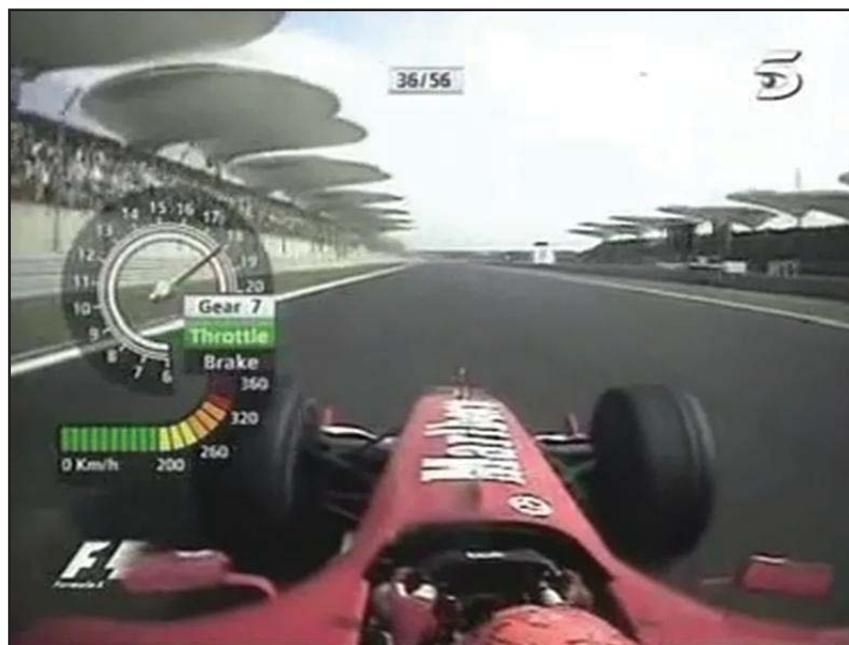
Figura 2. Grafismo que muestra la velocidad, la aceleración, las revoluciones y la marcha del monoplaza.
