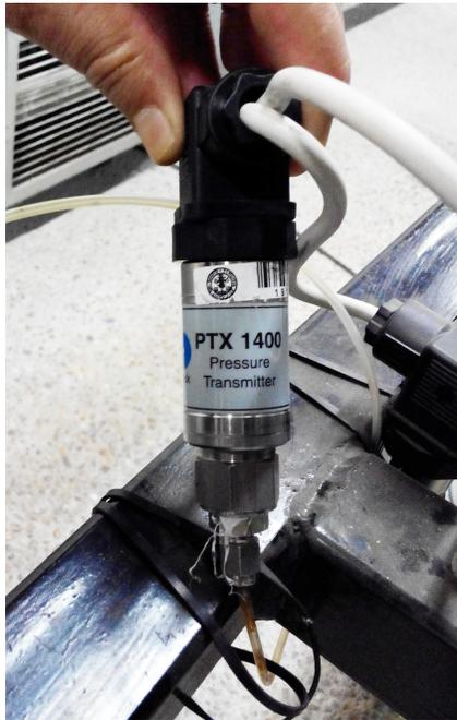
Figura 2.3.6: Detalle del sensor de presión modelo PTX 1400
