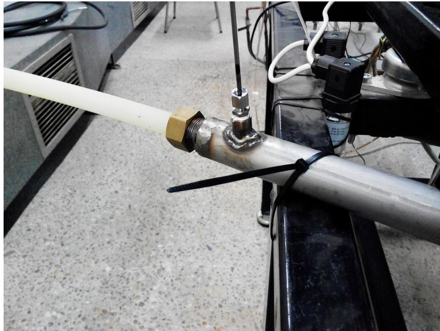
Figura 2.3.8: Detalle del sensor de  $T^a$ , constituido por un termopar
