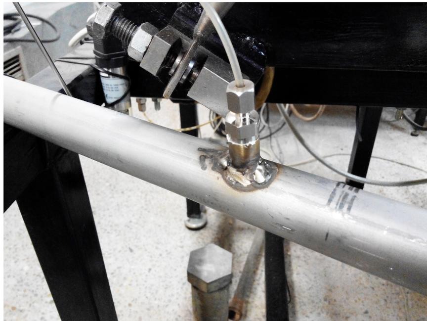
Figura 2.3.7: Detalle de la toma del sensor de presión
