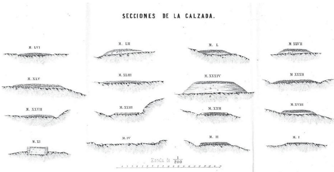
Figura 2 - Secciones de la calzada de Uxama a Augustobriga según E. Saavedra.
