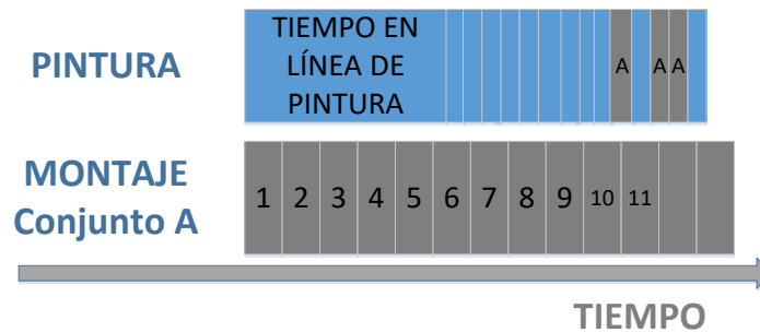
Figura 3. 6 Línea de pintura no nivelada
