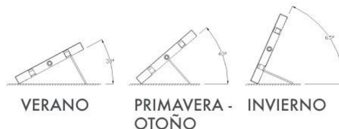
*Figura 63 - Orientación estacional de los paneles solares*
