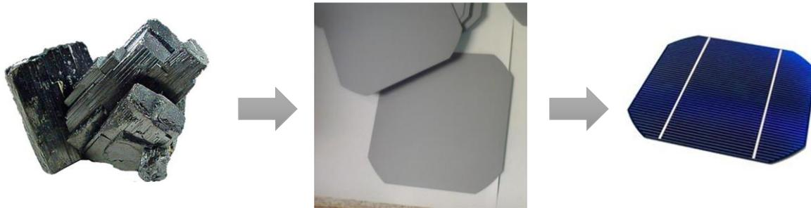
*Figura 45 - Fabricación de una célula solar*
