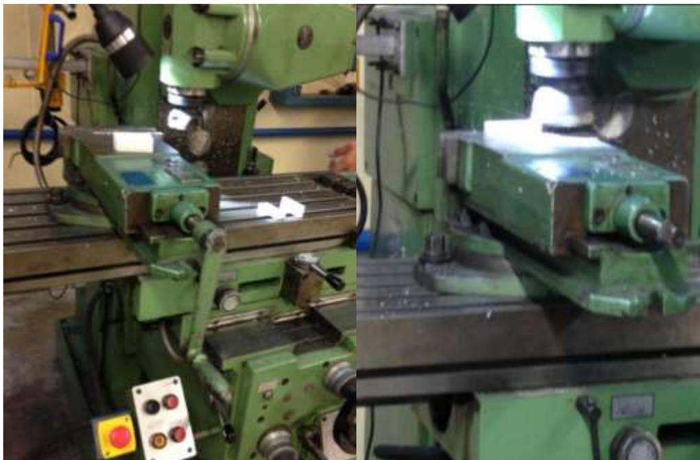
Figura 4.2.5.3: Mecanización de refrentado de piezas con fresadora.
