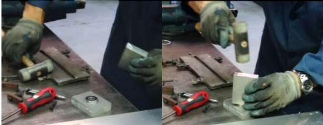
Figura 4.2.8.1: Insertar rodamientos en el soporte husillo.
