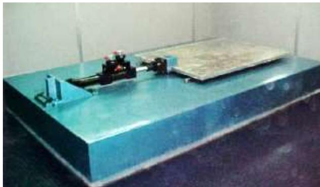
Figura 3.4.1: Fotografía de mesa vibratoria accionada por actuador hidráulico [Ref. Art. 2].
