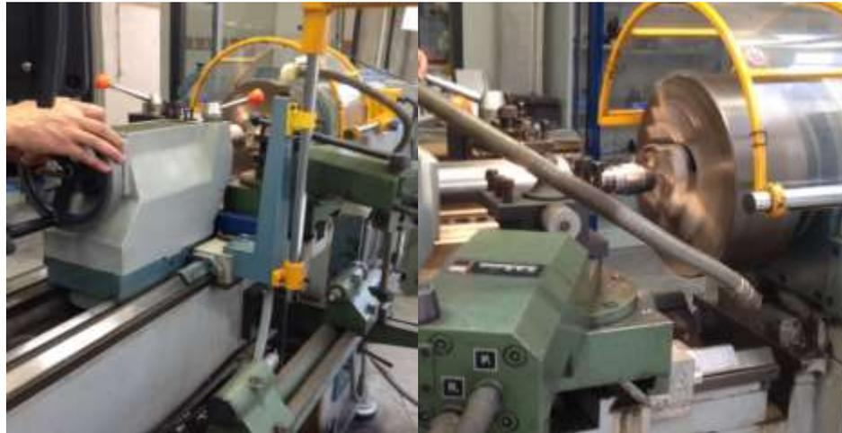
Figura 4.2.3.5: Mecanización del taladro central.
