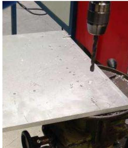
Figura 4.2.2.1: Proceso de taladrado de la plataforma.
