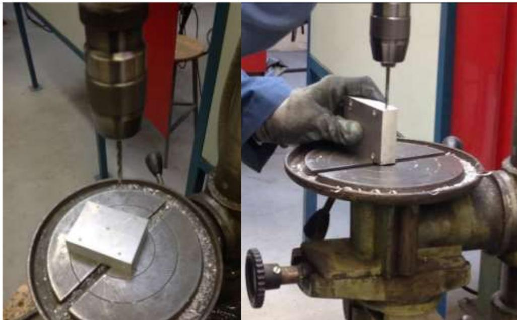
Figura 4.2.3.2: Mecanizado de los taladros en el soporte del husillo.
