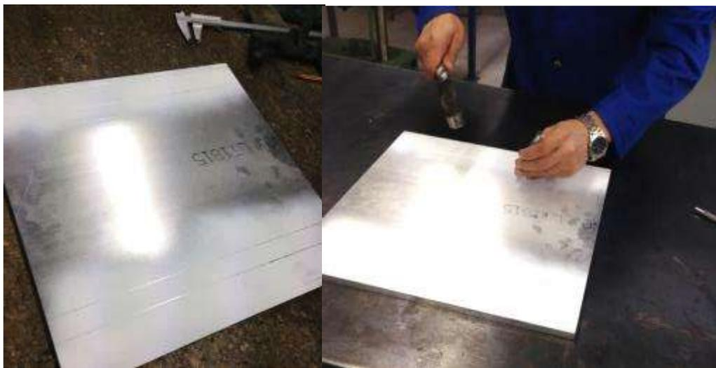
Figura 4.2.1.2: Medición y marcado de los taladros.
