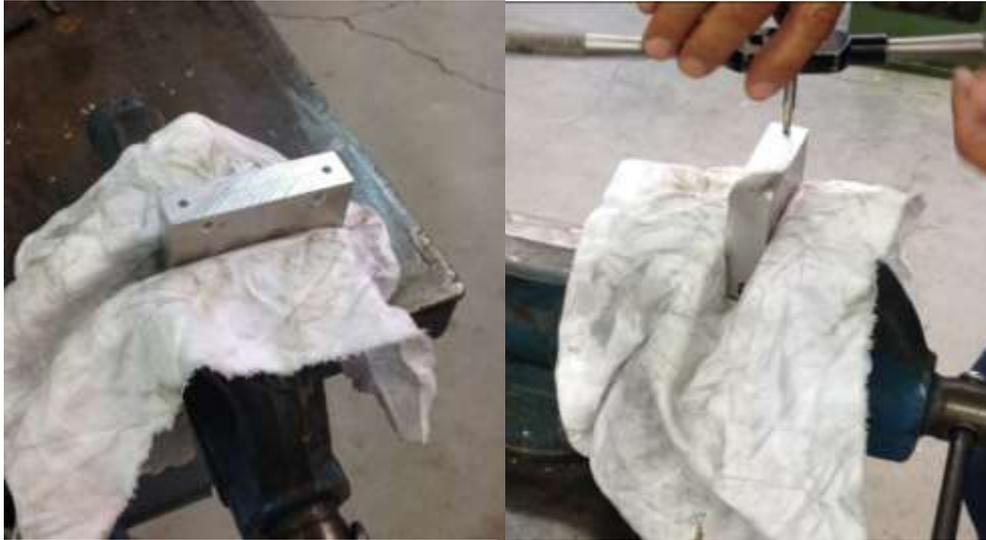
Figura 4.2.3.3: Mecanizado de las roscas de anclaje.
