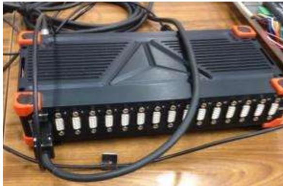
Figura 5.6.1: Equipo de adquisición de datos, SIRIUS.
