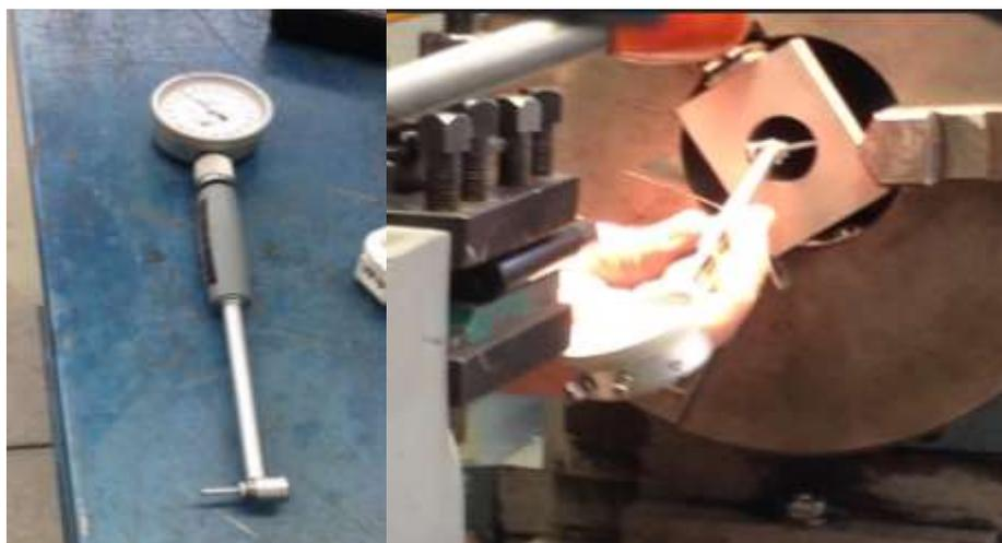
Figura 4.2.4.6: Medición con el reloj comparador.
