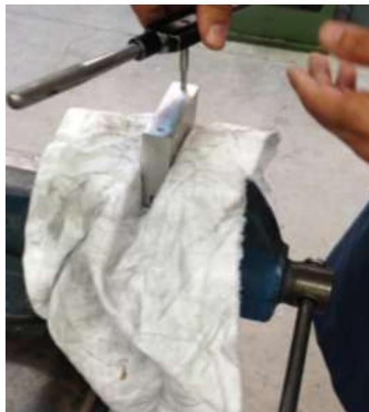
Figura 4.2.4.8: Mecanización de las roscas.
