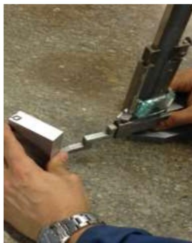
Figura 4.2.4.2: Medición y marcaje con el gramil de precisión.
