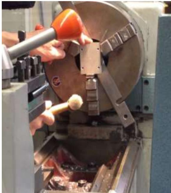
Figura 4.2.3.4: Centraje de la pieza en el plato de tres garras para mecanizado en el torno
