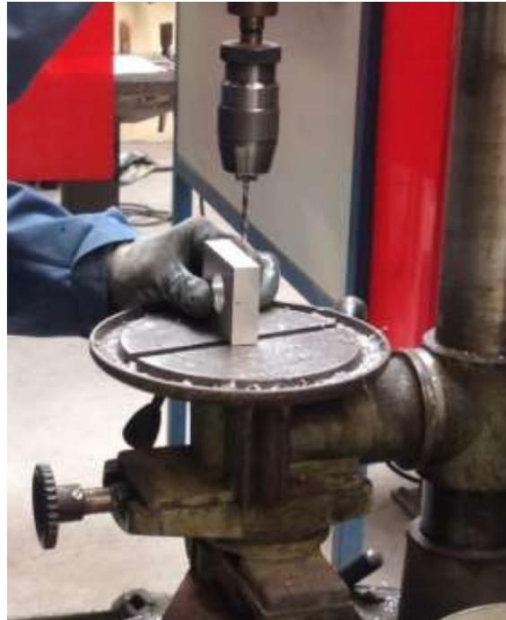
Figura 4.2.4.7: mecanización en el taladro de columna.
