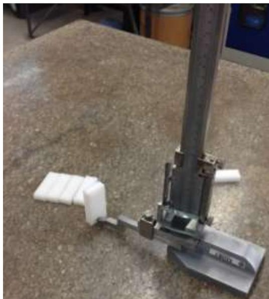
Figura 4.2.5.5: Medir y marcar la posición de los taladros con el gramil.
