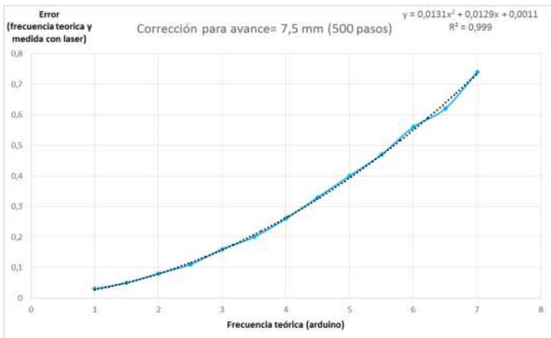
Figura 5.6.12: Gráfica para el cálculo de la corrección de la frecuencia medida (500 pasos).
