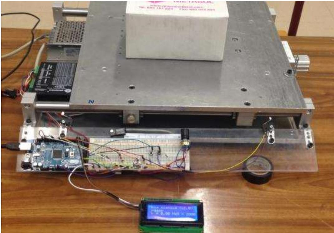
Figura 5.4.4.1: Instalación completa de controladores (*display* LCD, 2 pulsadores, potenciómetro, conmutador y 3 finales de carrera).
