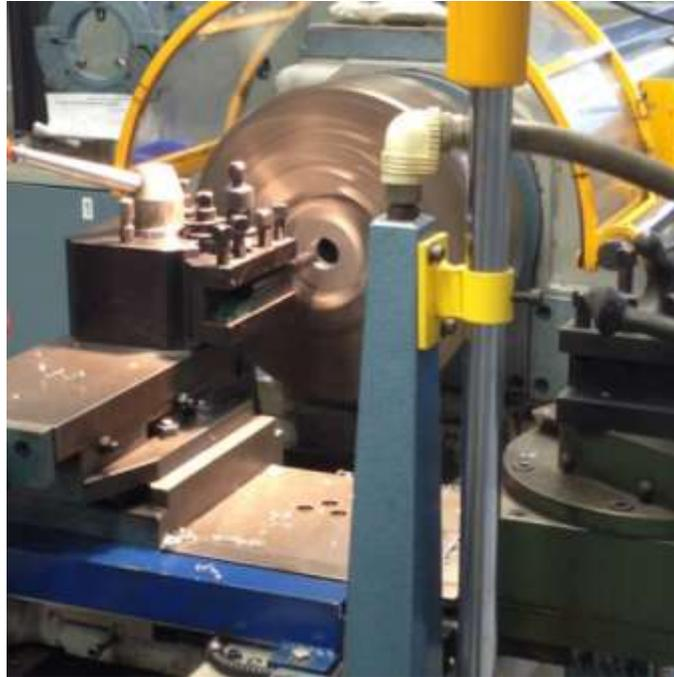
Figura 4.2.4.5: Mecanizado del apriete con torno.
