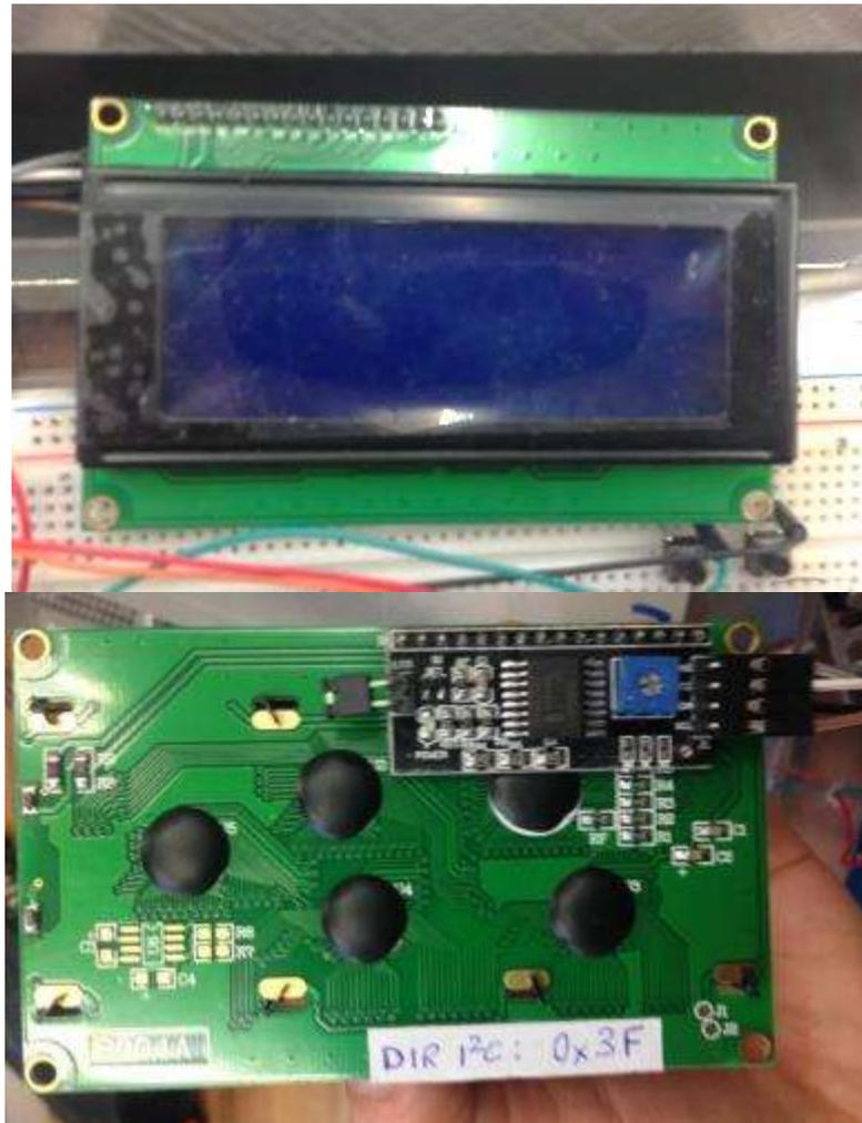
Figura 5.4.1.1: Pantalla LCD de 20x4 segmentos.
