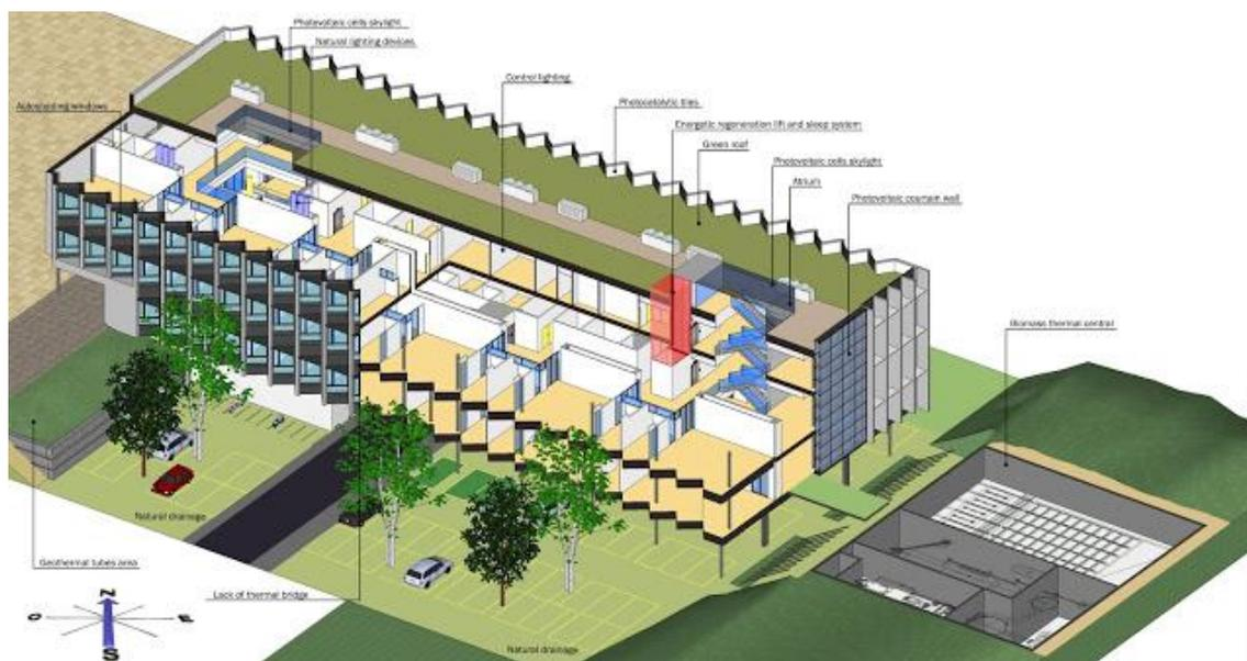
Figura I.10 Sección axonométrica. Pozos de luz, aparcamiento abierto y central de biomasa
