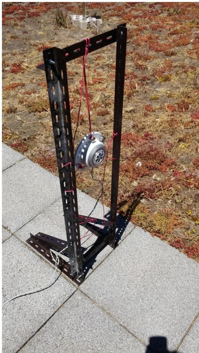
**Figura I.73 Piranómetro con la estructura**
