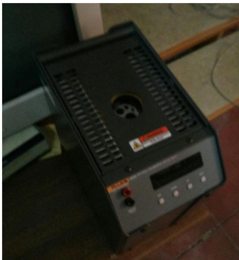
**Figura I.44** Horno de calibración
