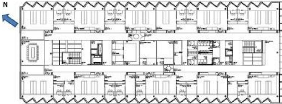
Figura I.9 Planta tipo. (Efecto dentado en el diseño de huecos para reorientar los huecos en fachadas Norte-Este y Sur-Oeste.)
