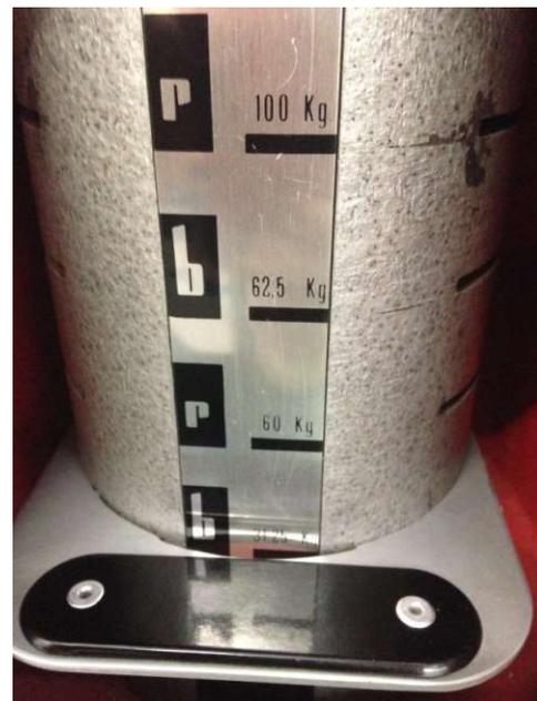
Ilustración 7.19: Izquierda: durómetro empleado en la realización del ensayo. Derecha: carga empleada durante el ensayo.
