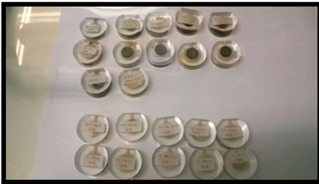
Ilustración 7.14: Resultado tras realizar el empastillado correspondiente de las probetas.
