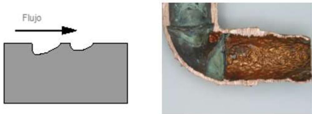
Ilustración 5.5: Corrosión por erosión. [53]
