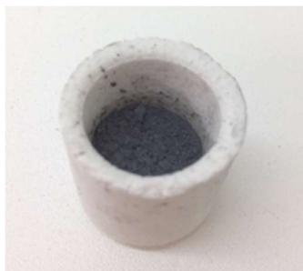
Ilustración 7.4: Recipiente para realizar la presinterización con el polvo ya aleado.
