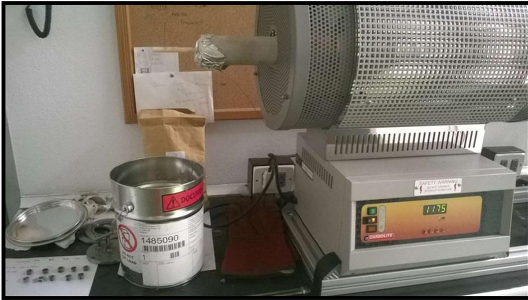
Ilustración 7.10: Lateral del horno de donde parte una cuerda metálica que va unida al soporte cerámico sobre el que están las probetas, para permitir su rápida extracción directamente al cubo relleno de agua destilada.
