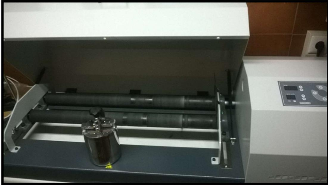
Ilustración 7.2: Molino empleado para conseguir la aleación mecánica.
