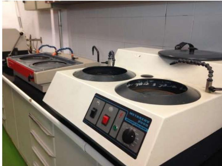
Ilustración 7.15: Equipos empleados para realizar el desbaste de las probetas.
