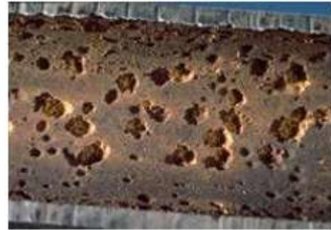
Ilustración 5.2: Corrosión por picaduras. [53]
