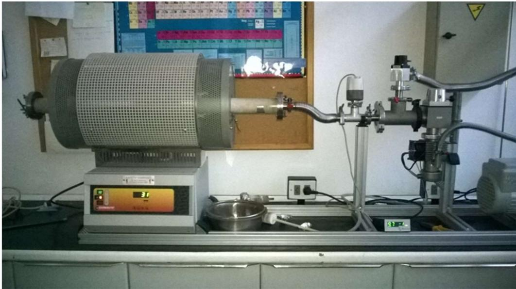
Ilustración 7.8: Horno cerámico horizontal Carbolite STF 15/180 realizando el proceso de sinterizado.
