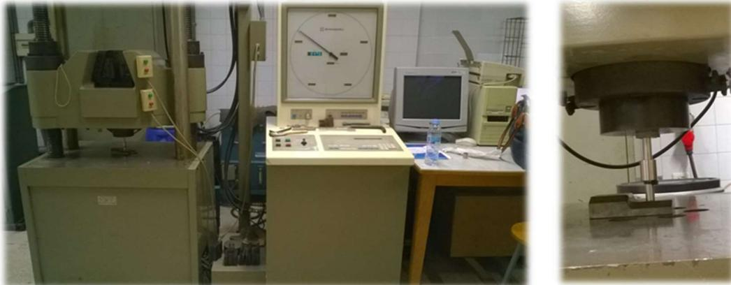
Ilustración 7.5: Izquierda: Máquina de ensayos tracción-compresión. Derecha: detalle de los pistones y camisa empleados.
