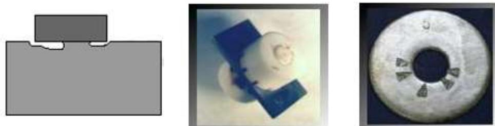
Ilustración 5.3: Corrosión por grietas. [53]
