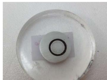
Ilustración 7.30: Izquierda: Representación del ensayo de desgaste circular (pin-on-disk). Derecha: Probeta tras la realización de un ensayo circular
