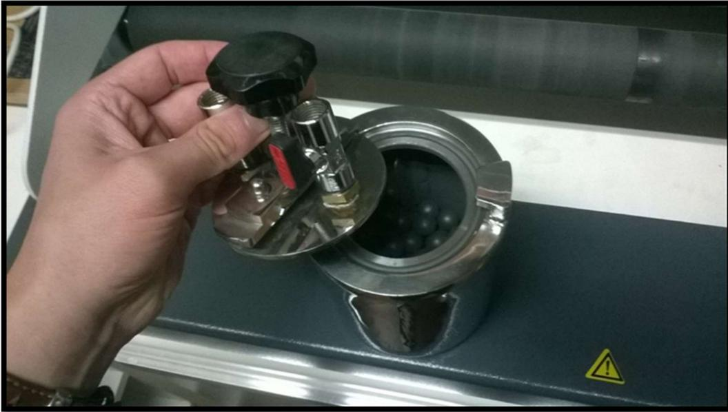
**Ilustración 7.1:** Detalle del cilindro en cuyo interior se aprecian los polvos a alear y las bolas de acero, así como la tapa y las válvulas de las que dispone.
