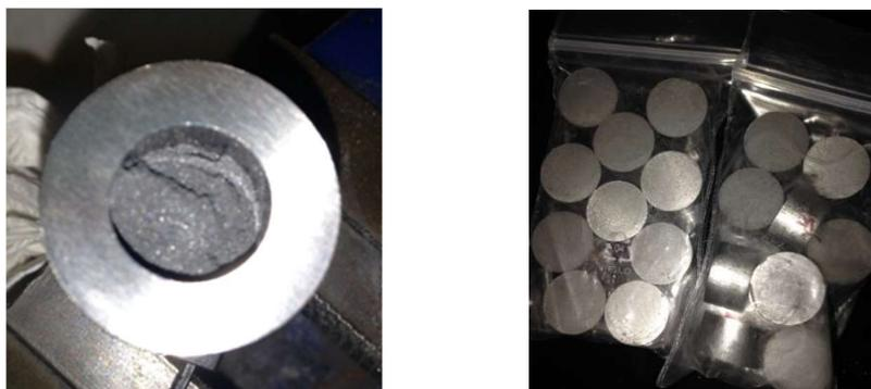
Ilustración 7.6: Izquierda: Muestra de la camisa que contiene el polvo aleado. Derecha: Parte de las probetas obtenidas durante el compactado.
