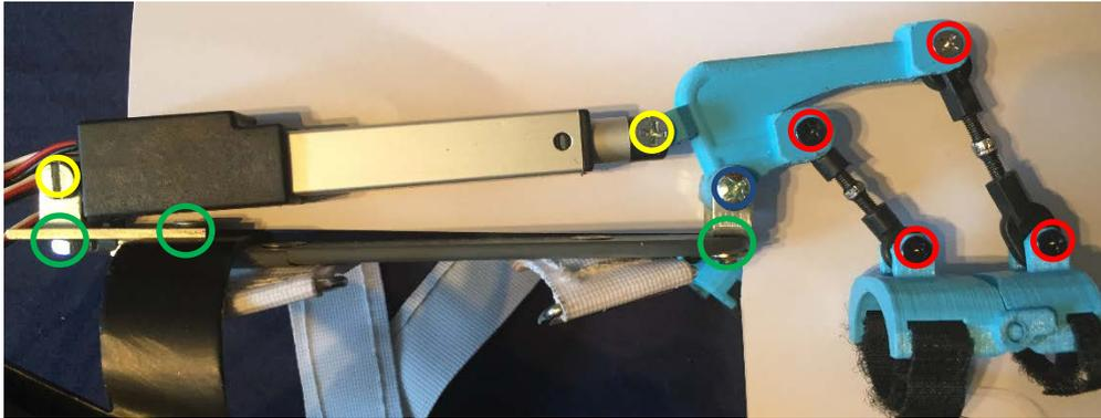
*Figura 4.6: identificación tornillería*
