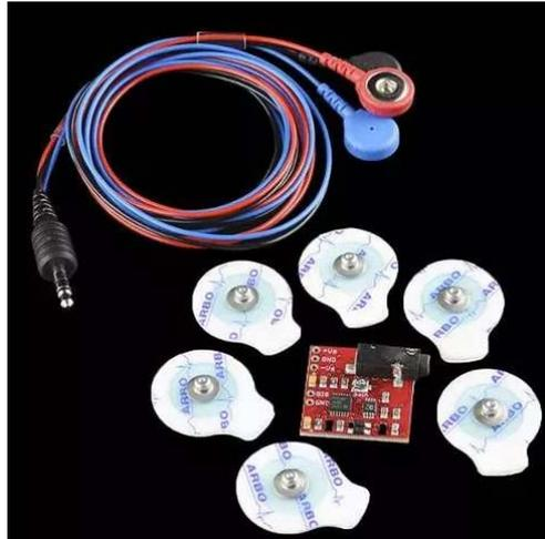
*Figura 1.5: Sensores para electromiografía de superficie*
