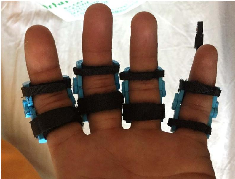
*Figura 4.3: Elementos de sujeción de las falanges a los dedos*
