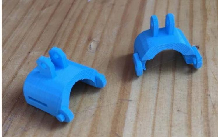
*Figura 3.7: Partes que componen los elementos de sujeción de las falanges*
