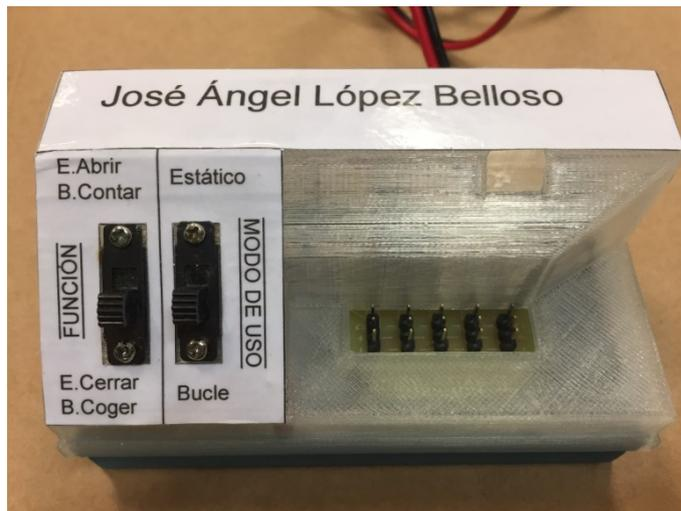
Figura 5.10: Caja de control con serigrafía
