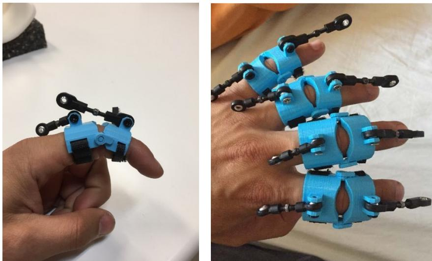
*Figura 4.2: Unión de los elementos de sujeción de las falanges con las barras extensoras*
