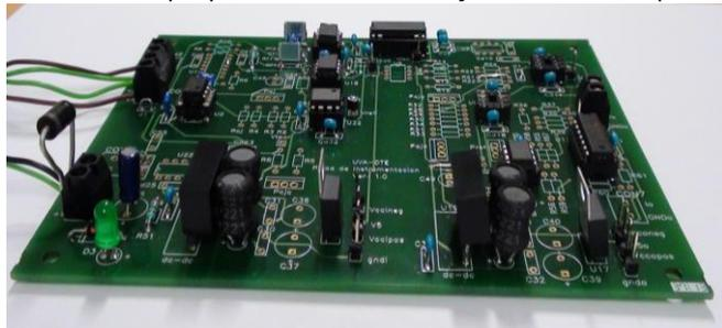
**Figura 5.** Tarjeta base empleada en la asignatura Instrumentación Electrónica del GIElyA.
