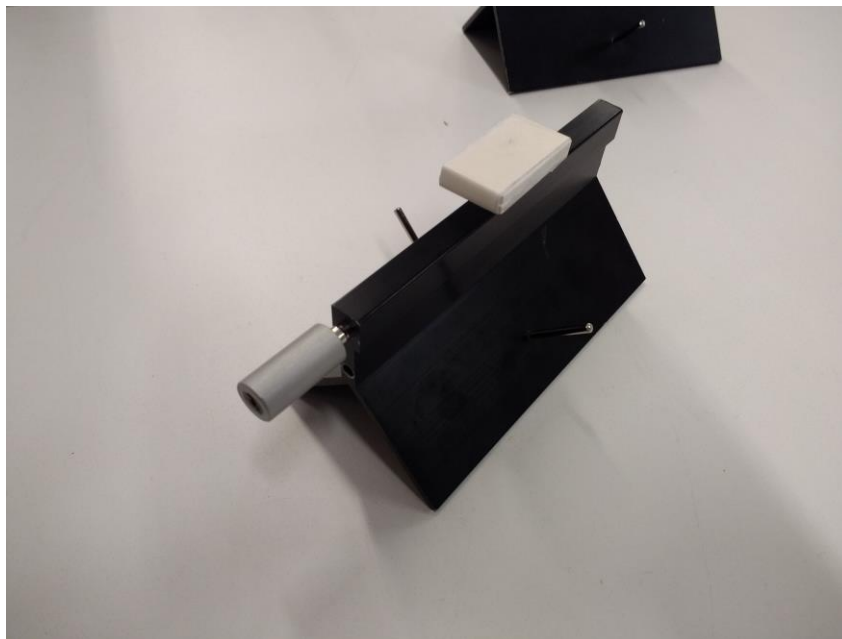
Fig 18. Carro del Móvil B equipado con la plastilina
