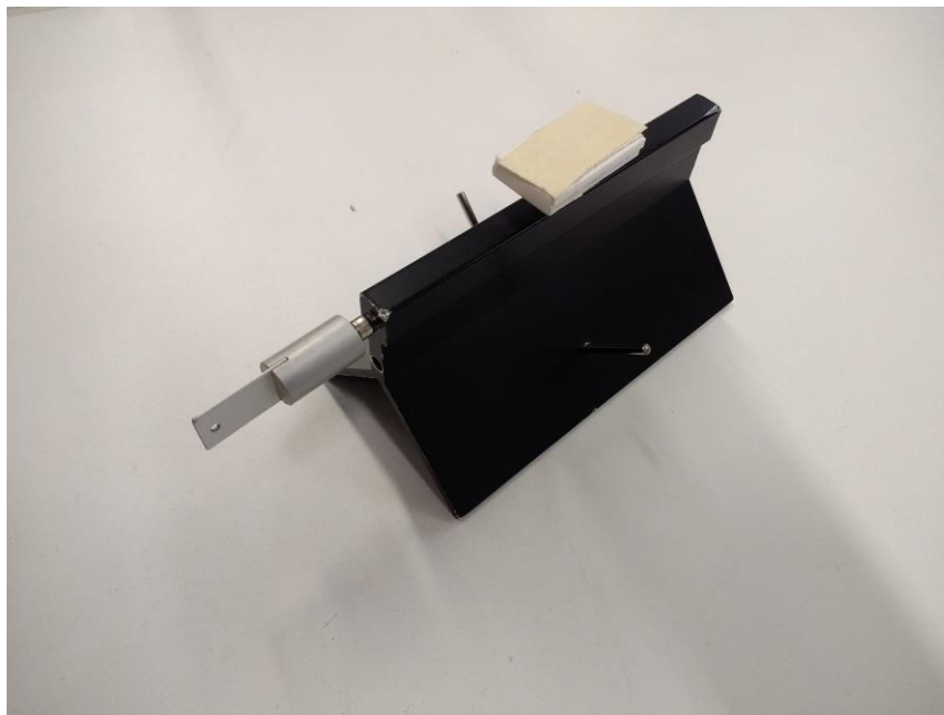
Fig 15. Carro del Móvil A equipado con el cuchillo
