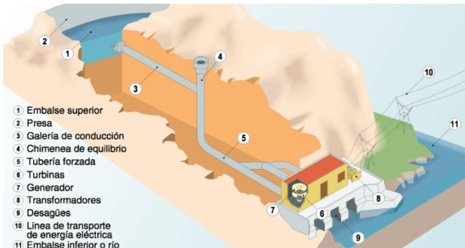
**FIGURA 3.10. Esquema de funcionamiento de una central de bombeo. Fuente: UNESA**
