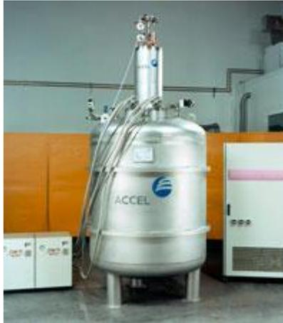
**FIGURA 3.7. Almacenamiento magnético de 2 MJ, Accel, Bruker. Fuente: [8]**
